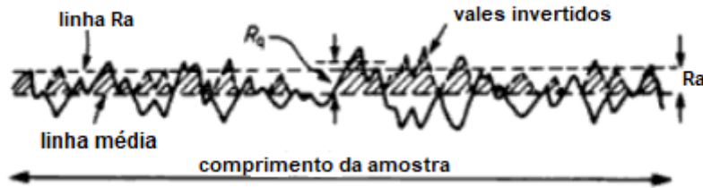
Figura 6 – Ilustração do parâmetro de rugosidade R_a [20]
