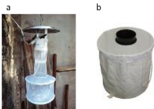
Figura 6: Armadilhas utilizadas na captura dos culicídeos. (a): armadilha do tipo Shannon e (b): armadilha elétrica BG Sentinel®
