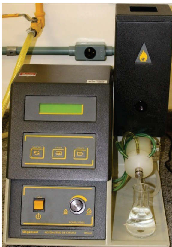
Fotografia 6 – Imagem do fotômetro de chama modelo DM-61, da marca Digimed
