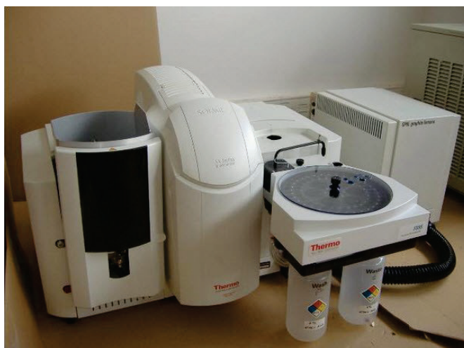
Fotografia 5 – Imagem do espectrômetro de absorção atômica modelo SOLAAR M5, da marca Thermo Scientific
