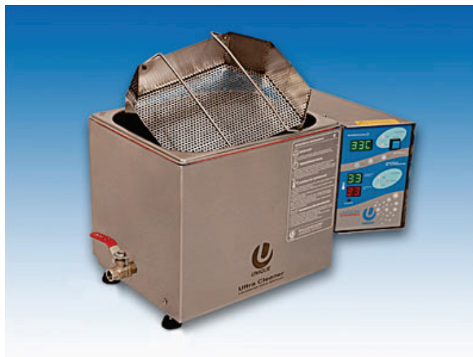
Fotografia 3 – Imagem do banho ultrassônico modelo USC 2800, da marca Unique
