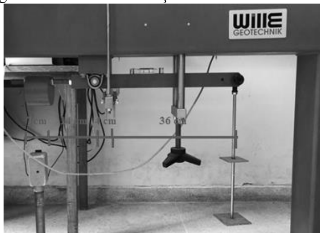
Figura 53 – Detalhe do braço de alavanca da LO 2900.
