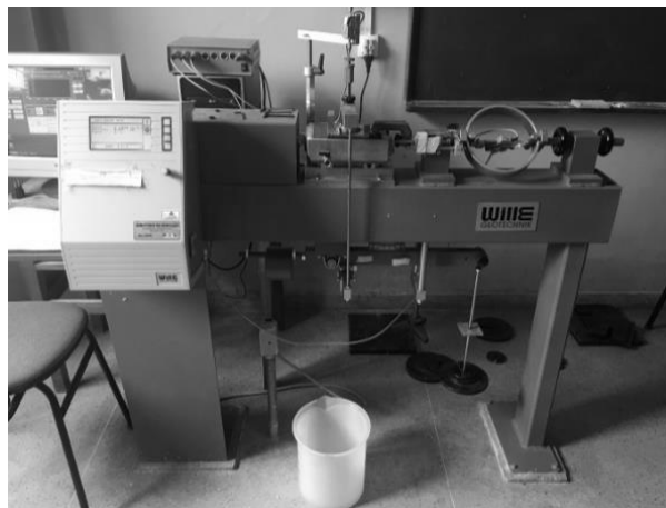
Figura 45 – Máquina de Cisalhamento de Direto modelo LO 2900 da Wille Geotechnik.
