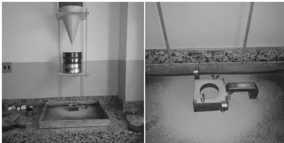
Figura 51 – Pluviação de areia com o funil de \varnothing = 5.0 mm na célula de cisalhamento.
