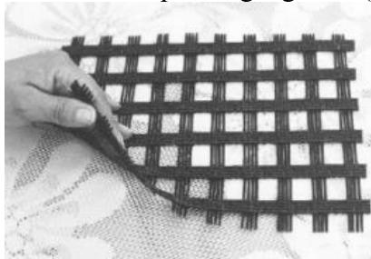
Figura 16 – Exemplo de geogrelha (GG).
