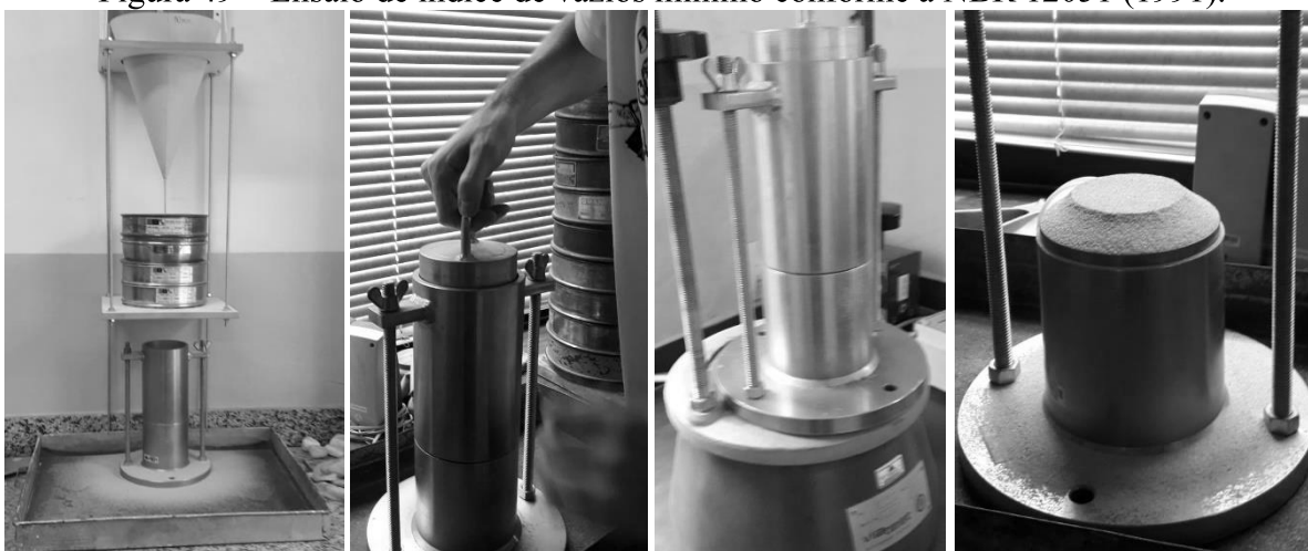
Figura 49 – Ensaio de índice de vazios mínimo conforme a NBR 12051 (1991).
