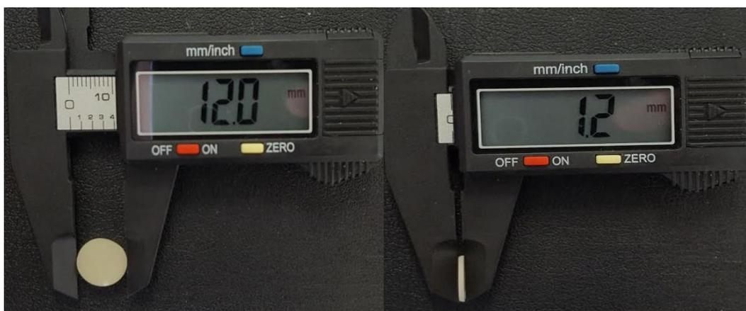
Figura 3 – Dimensão final dos discos. A) diâmetro final dos discos; B) espessura final dos discos.
