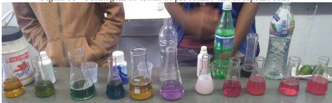
Figura 10 – Montagem da escala de pH usando chá de repolho roxo
