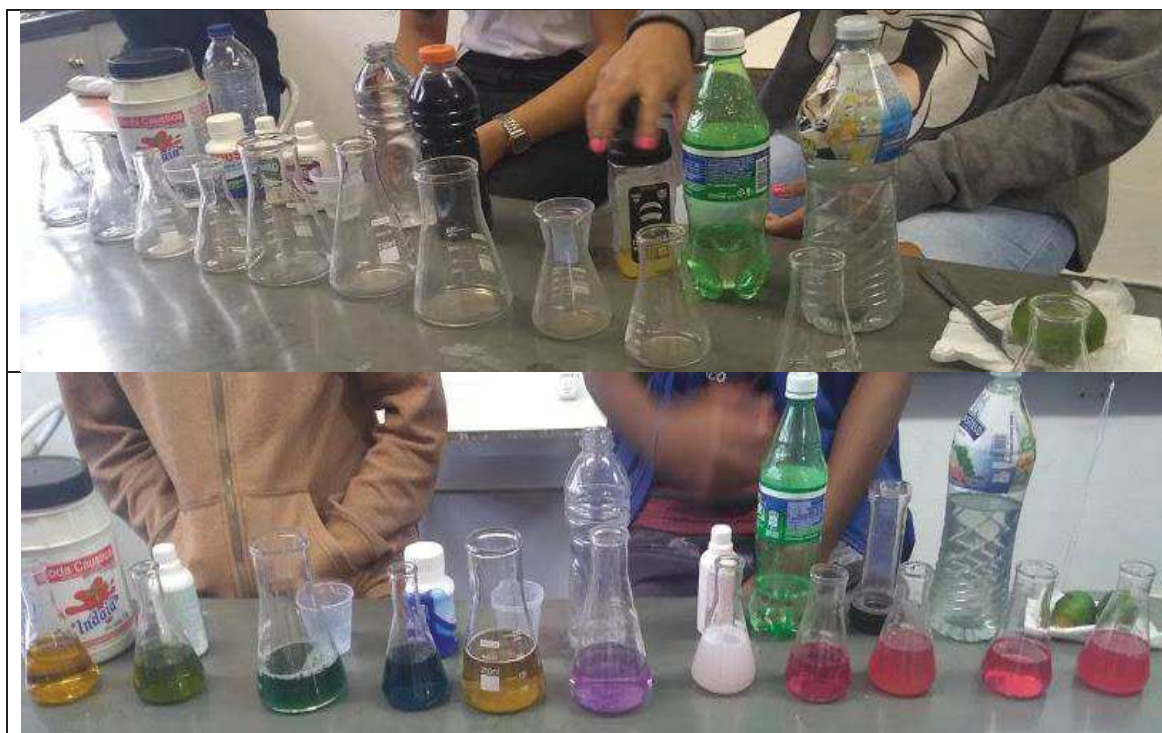
Figura 50 – Montagem da escala de pH usando chá de repolho roxo
