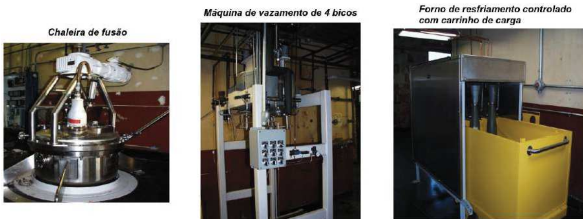
Figura 100 – Equipamentos usados no processo de carregamento.
