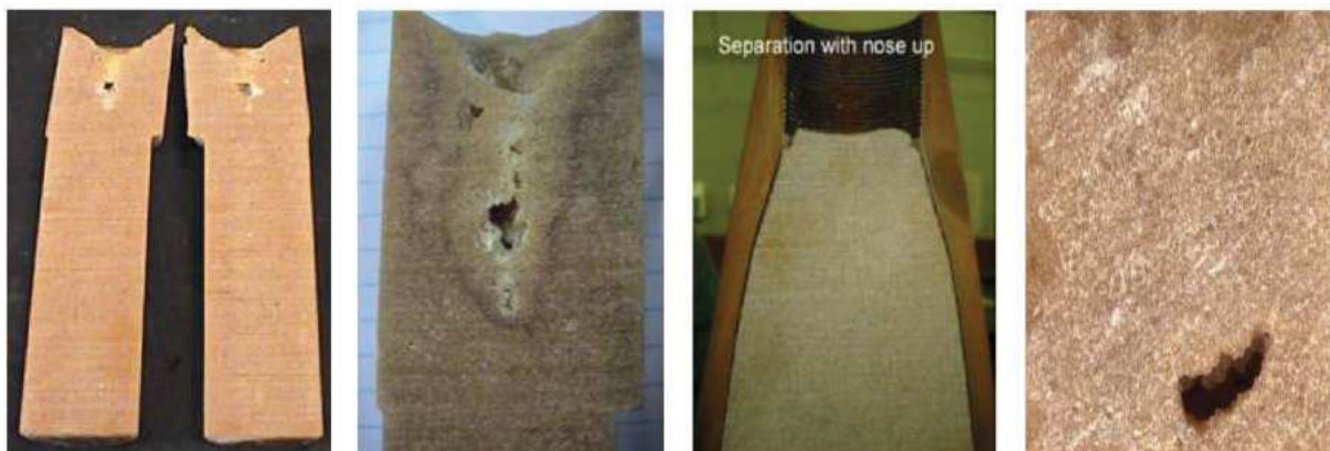
Figura 102 – Alguns defeitos no explosivo final solidificado.
