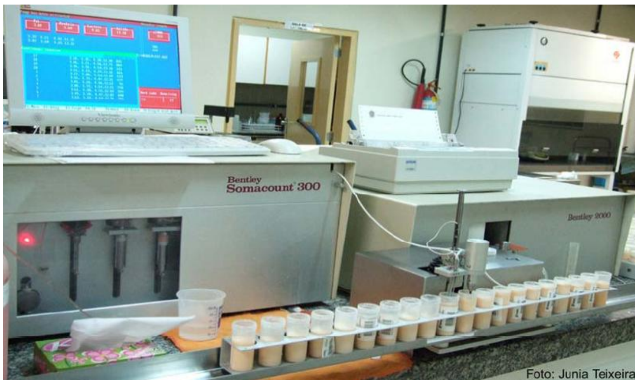
Figura 2: Equipamento eletrônico Somacount 300 da Bentley Instruments Incorporated® para contagem de células somáticas em amostras de leite.
