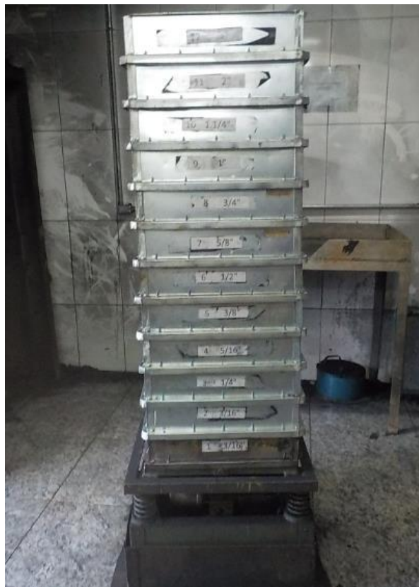
Figura 19: Peneiras utilizadas para o ensaio de granulometria de minérios (da peneira 9 até a peneira 1).
