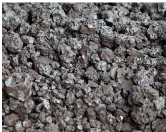
Figura 8: sinter feed, material sinterizado utilizado em altos fornos
