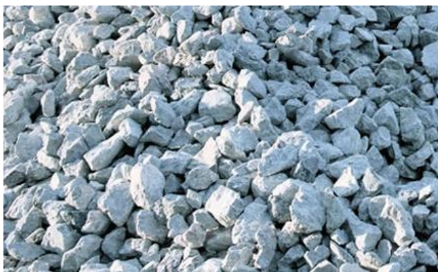
Figura 5: Imagem de calcário dolomítico, um dos fundentes utilizados nos fornos em estudo.
