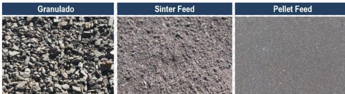
Figura 6: tipos de minério de ferro mais utilizados em altos fornos
