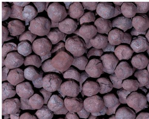
Figura 11: Pellet feed, ou pelota. Material pelotizado utilizado em altos fornos
