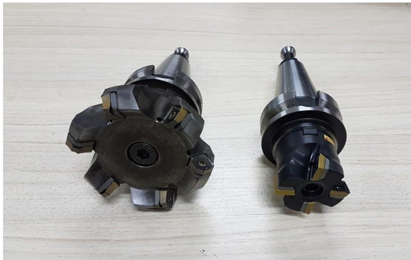
Figura 23 – Fresas de topo planetárias utilizada na usinagem
