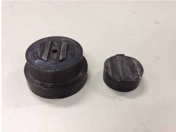
Figura 6 – Ferramenta utilizada no forjamento em matriz aberta.
