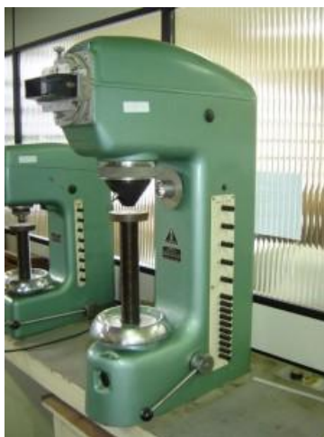
Figura 9 – Medidor de dureza Vickers
