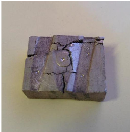
Figura 13 – Amostra 1 após o forjamento
