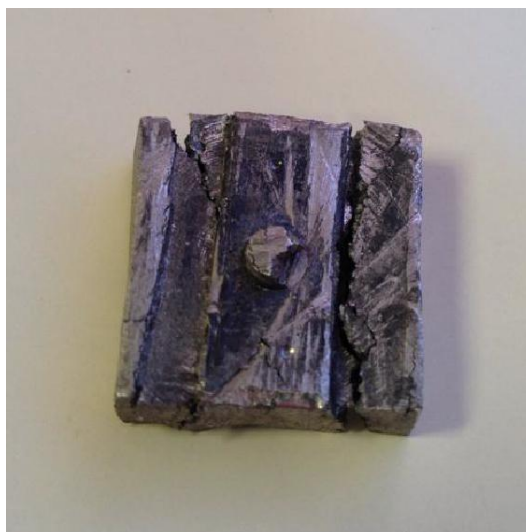
Figura 15 – Amostra 4 após o forjamento
