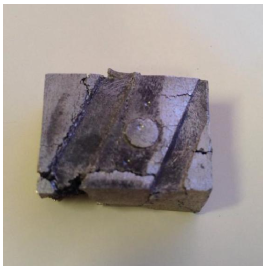
Figura 14 – Amostra 2 após o forjamento
