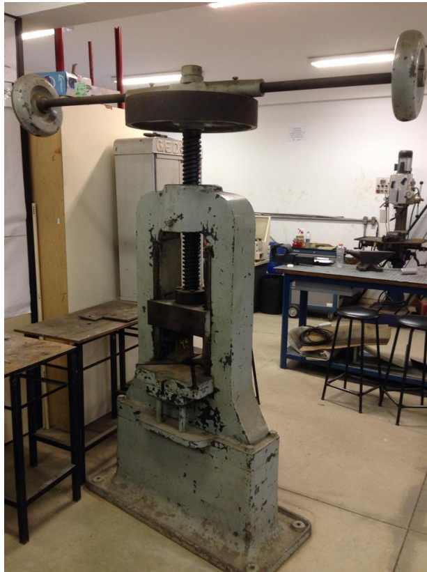
Figura 7 – Prensa manual do tipo parafuso.
