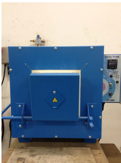
Figura 5 – Forno mufla SPLabor modelo SP1200.
