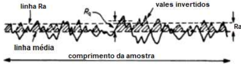
Figura 6 – Ilustração do parâmetro de rugosidade R_a [20]
