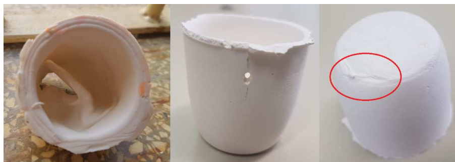
Figura 18 – Falhas na estrutura devido à utilização de talco em pó
