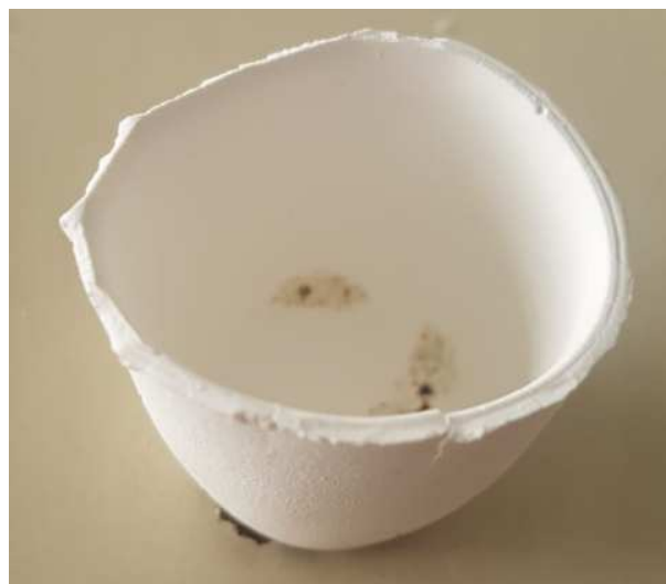
Figura 15 – Cadinho a verde após o forno a gás
