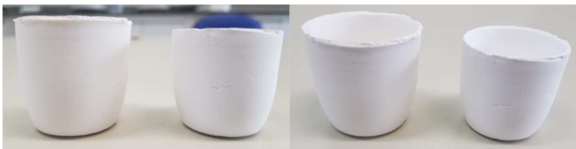
Figura 13 – Cadinhos antes e depois da sinterização a 1000°C
