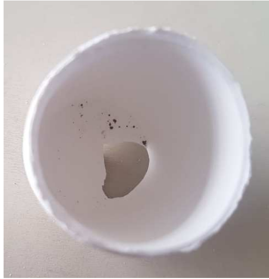
Figura 19 – Danificação dos cadinhos durante a retirada do forno
