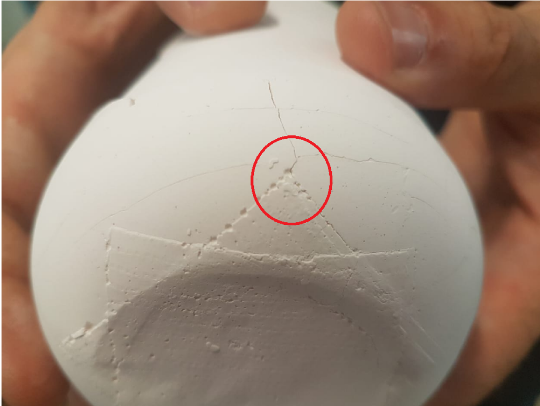
Figura 22 – Origem das rachaduras no cadinho grande sinterizado
