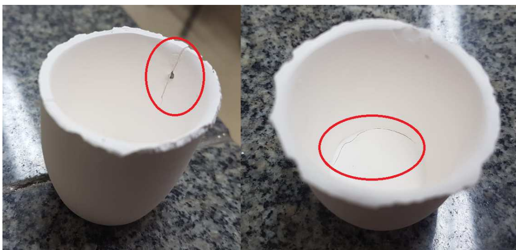
Figura 21 – Rachaduras nas falhas superficiais
