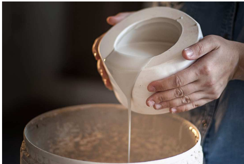
Figura 1 – Colagem de barbotina
