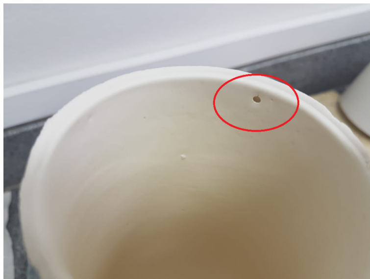
Figura 20 – Falhas na parede relacionadas a bolhas de ar
