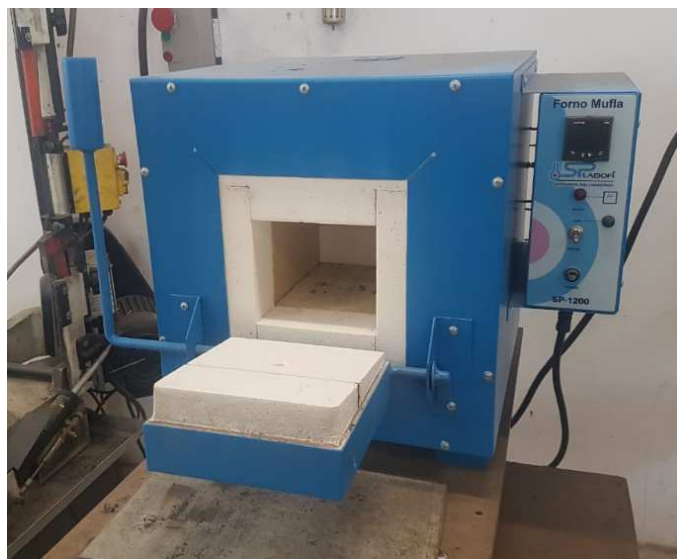
Figura 10 – Forno elétrico do laboratório da UFJF
