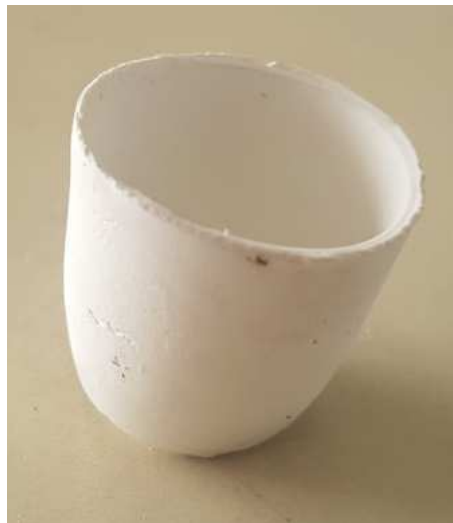
Figura 14 – Cadinho pré queimado após queima no forno a gás
