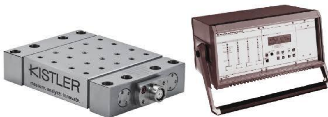
Figura 8: Dinamômetro Kistler 9257B e Amplificador Kistler 5019B
