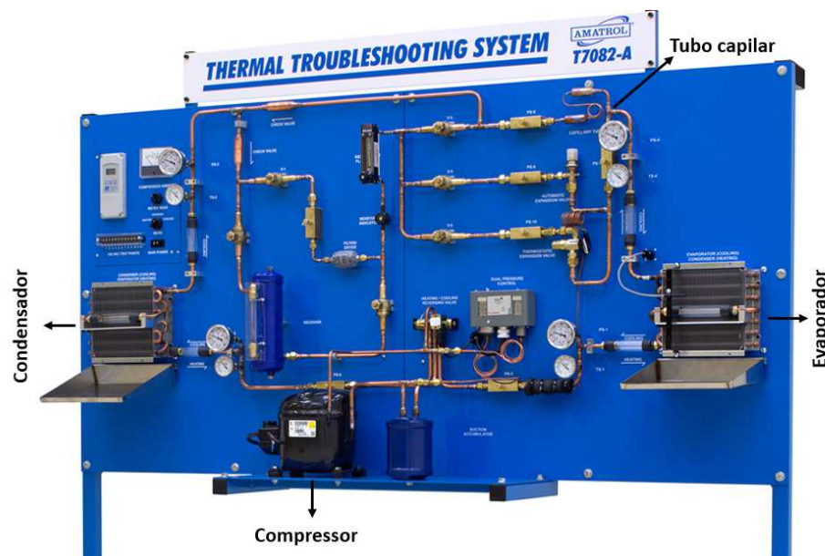
Figura 2 – Bancada Amatrol T7082 em destaque os componentes principais.
