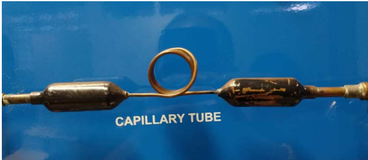
Figura 30 – Tubo capilar da bancada de refrigeração presente no LCTH.
