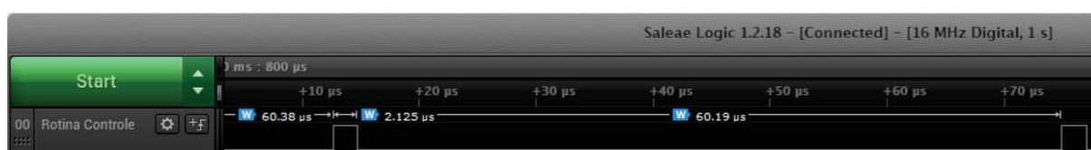
Figura 78 – Tempo dispendido na rotina de leitura das variáveis e cálculo das saídas de controle no modo de operação boost .
