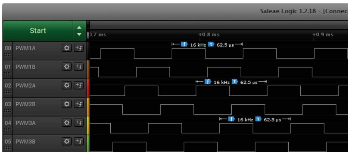
Figura 76 – Sinais PWM com razão cíclica de 50% e frequência de 16 kHz.
