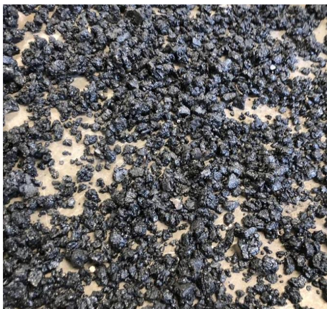
Figura 46 – Concreto asfáltico espalhado sobre bandeja metálica.
