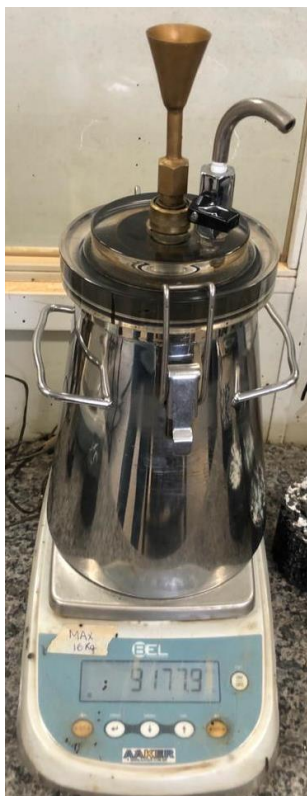
Figura 48 – Pesagem do recipiente com concreto asfáltico e água.
