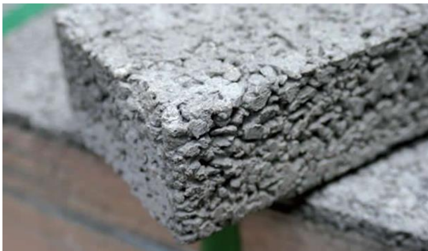
Figura 17 – Concreto permeável de cimento Portland.
