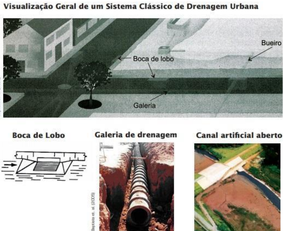
Figura 6 – Sistema clássico de drenagem urbana.
