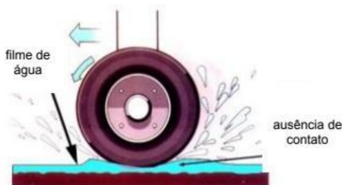
Figura 23 – Fenômeno de Hidroplanagem Dinâmica.
