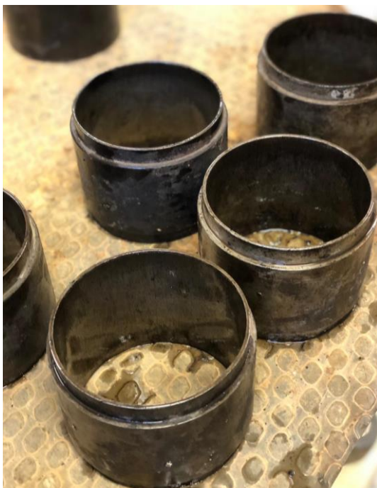
Figura 53 – Anéis de compactação.
