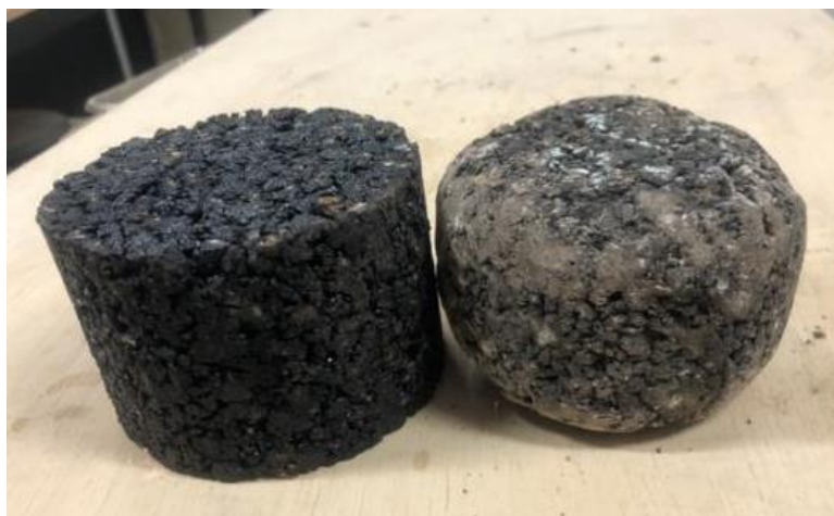
Figura 59 – Comparação de CP íntegro e após o ensaio.
