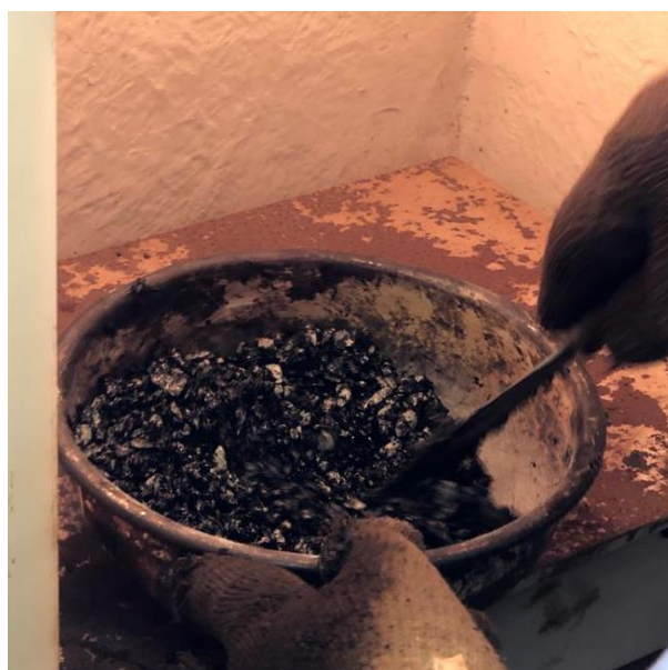
Figura 52 – Mistura dos elementos componentes do concreto asfáltico permeável.
