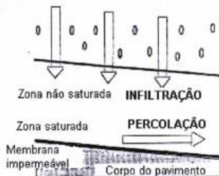
Figura 10 – Dinâmica da água nos pavimentos permeáveis.
