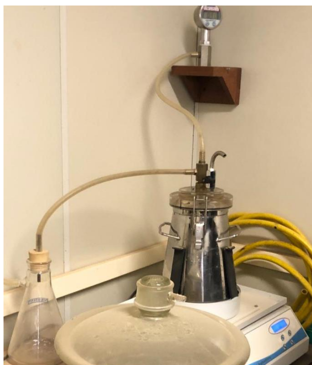
Figura 47 – Aplicação de pressão de vácuo.
