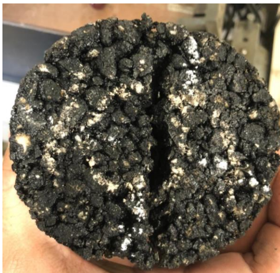
Figura 61 – CP após ruptura.
