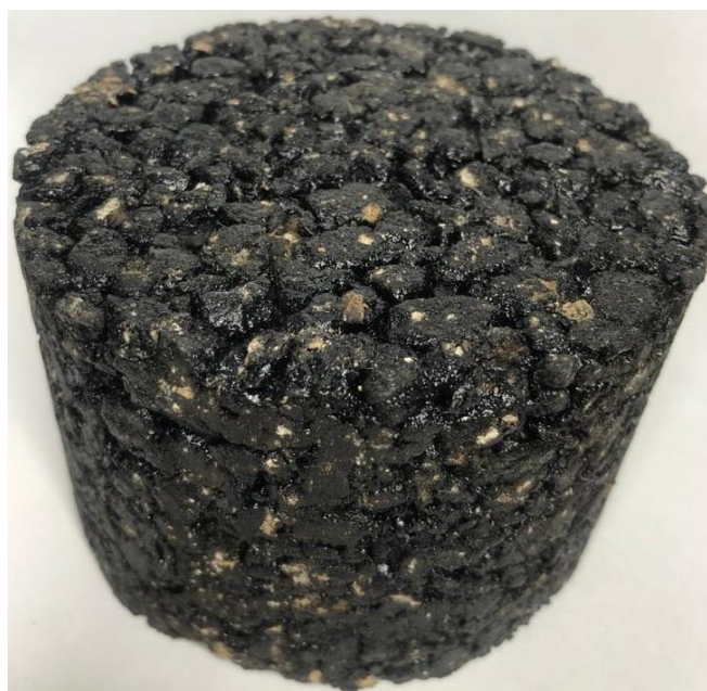
Figura 20 – Concreto Asfáltico Permeável logo após sua fabricação e compactação.
