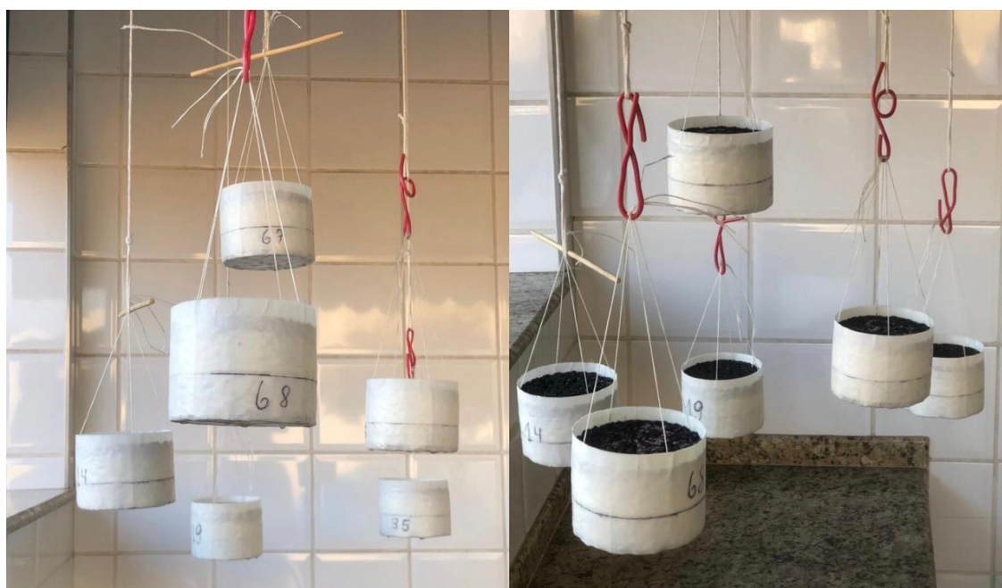
Figura 79 – Posicionamento dos CPs para aguardar a secagem.
