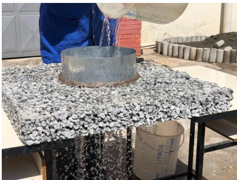
Figura 19 – Ensaio de permeabilidade em uma placa de concreto permeável.
