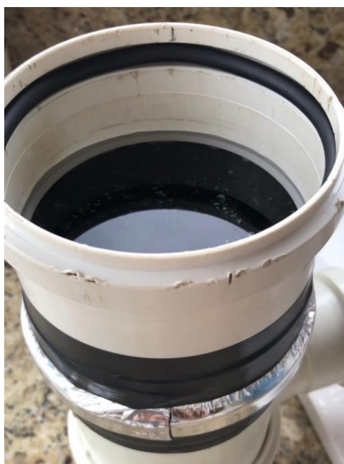
Figura 72 – Filme de água sobre o corpo-de-prova.
