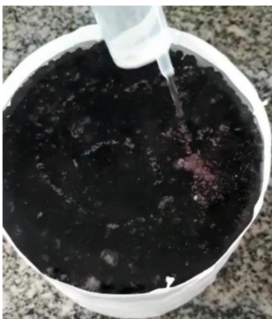
Figura 82 – Formação do filme de água sobre o corpo-de-prova.
