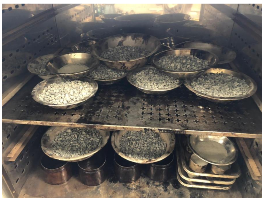
Figura 51 – Disposição dos agregados na estufa.
