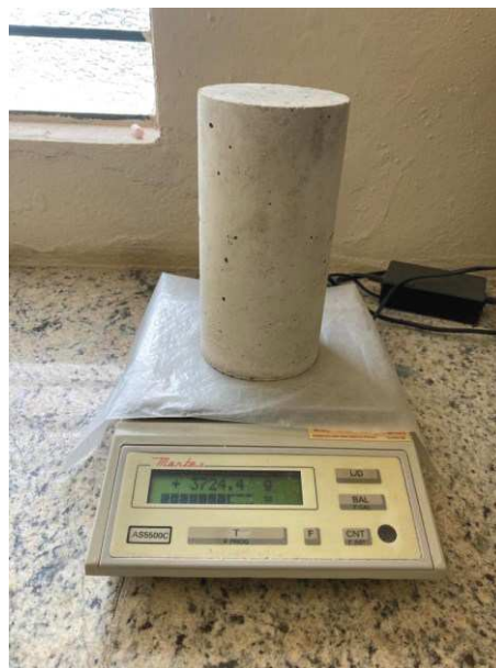
Figura 26 - Pesagem do corpo de prova seco.
