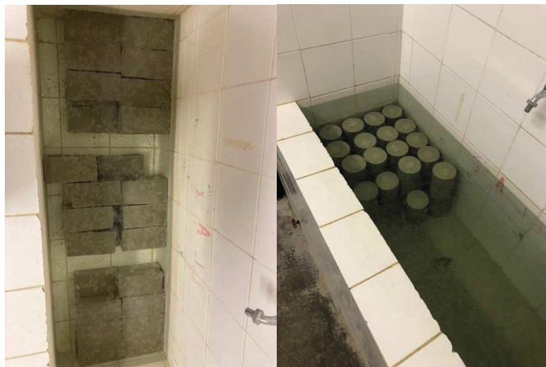
Figura 21 - Corpos de prova imersos em água.
