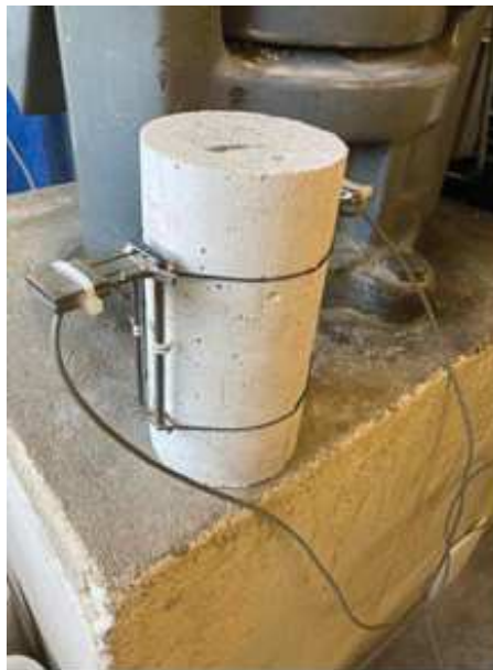
Figura 32 - Strain Gauge colocado no corpo de prova.
