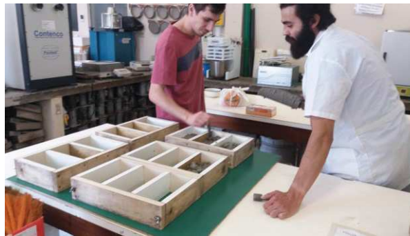
Figura 18 - Moldagem dos CP's prismáticos.
