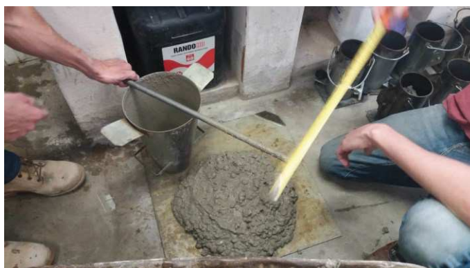
Figura 17 - Medição do abatimento.
