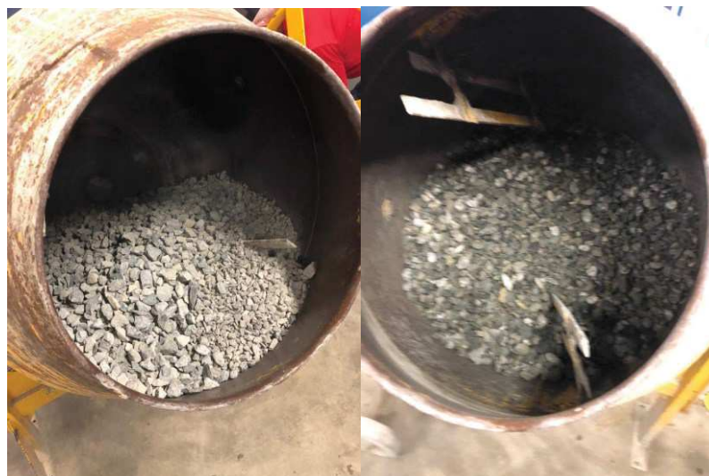
Figura 13 - Agregado graúdo em condição saturada com superfície seca.
