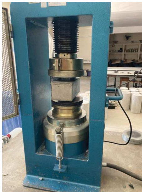
Figura 31 - Posicionamento do corpo de prova para o rompimento.
