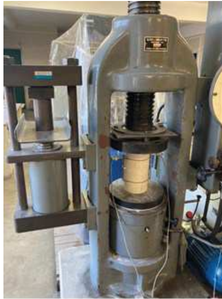
Figura 33 - Corpo de prova posicionado na prensa.
