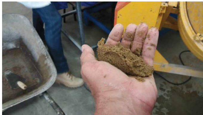
Figura 12 - Agregado miúdo em condição saturada com superfície seca.
