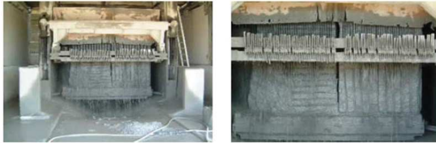
Figura 4 - Corte de blocos em tear tradicional.
