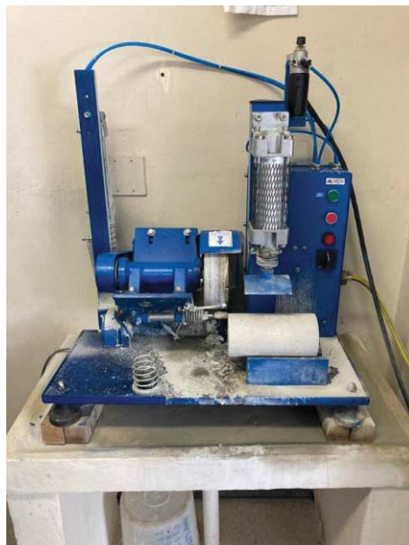
Figura 23 - Capeamento dos CP's cilíndricos.
