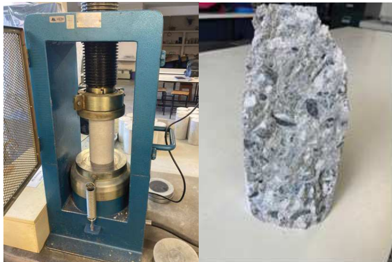
Figura 34 - Ruptura do corpo de prova cilíndrico.
