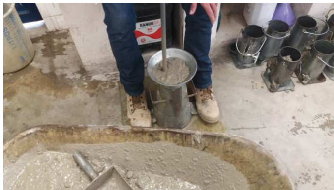
Figura 16 - Enchimento do molde.
