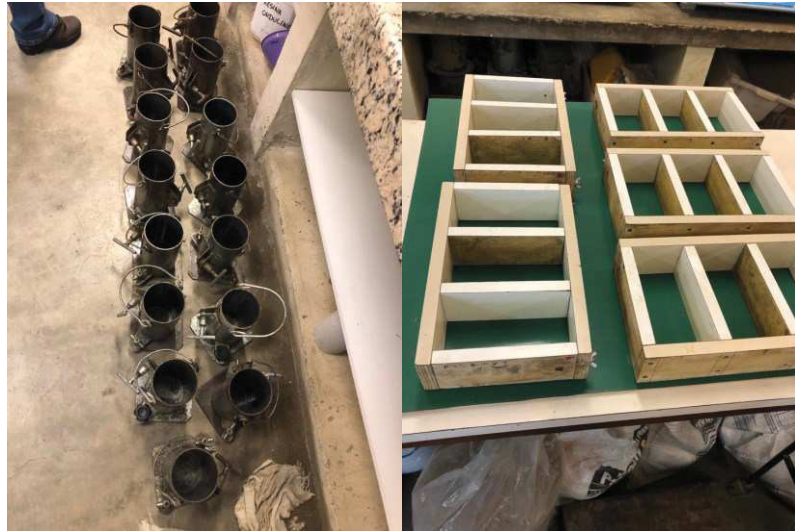
Figura 11 - Formas com desmoldante.
