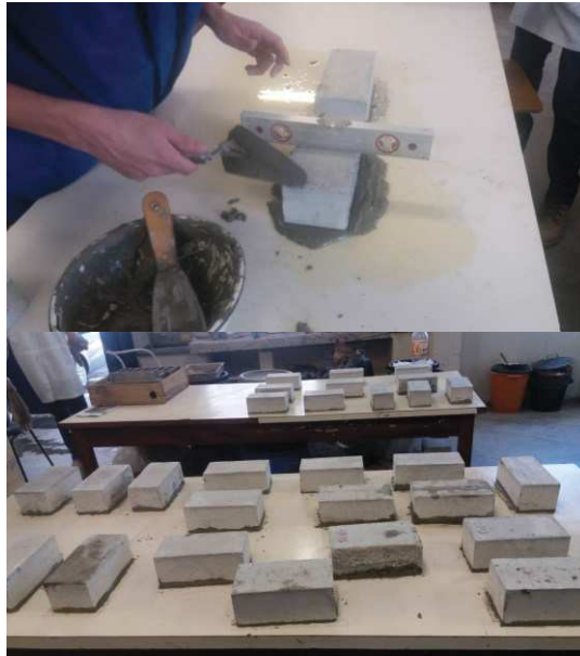
Figura 24 - Capeamento dos CP's prismáticos.
