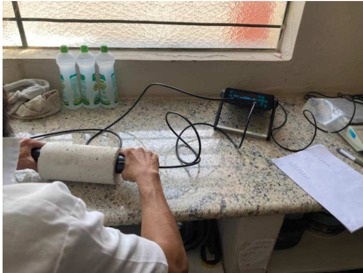
Figura 29 - Medição da velocidade.
