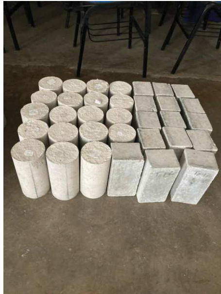
Figura 22 - Corpos de prova após o processo de cura.
