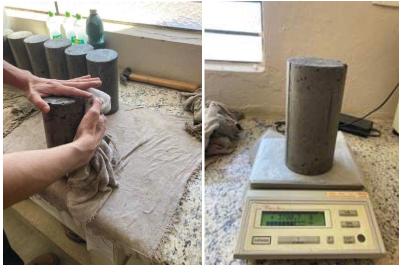
Figura 25 - Pesagem do corpo de prova saturado com superfície seca.
