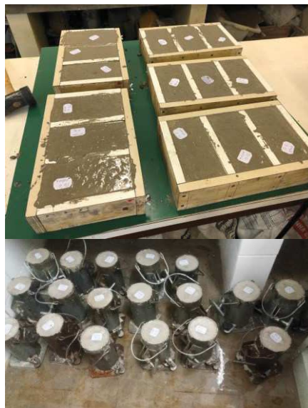
Figura 19 - Formas depois da moldagem.
