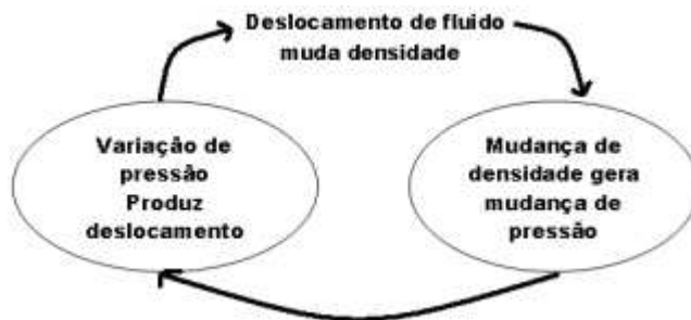
Figura 12 – Propagação de uma onda sonora.
