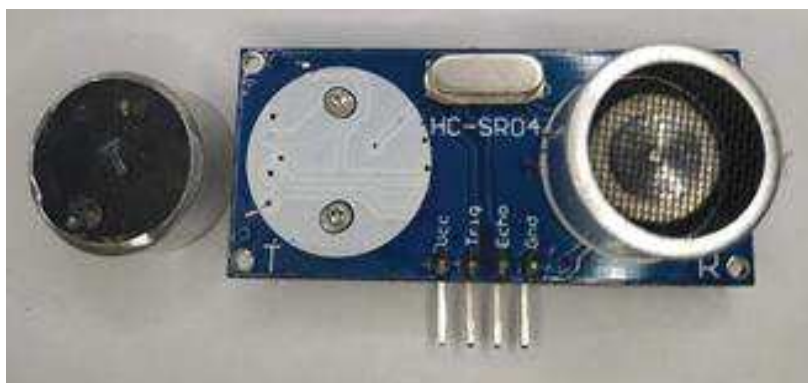
Figura 2 – Detalhes do transdutor retirado do sensor ultrassônico
