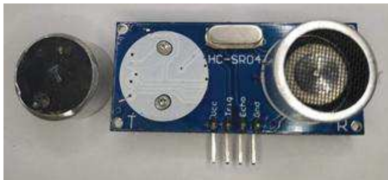
Figura 6 – Detalhes do transdutor retirado do sensor ultrassônico
