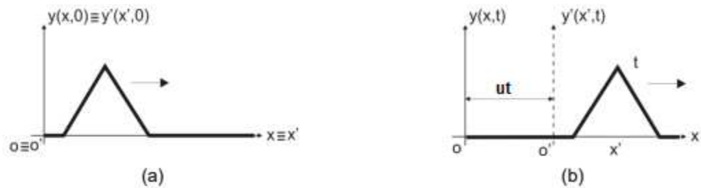
Figura 11 – Onda se deslocando (a) sistema em t=0 (b) sistema em um instante t .
