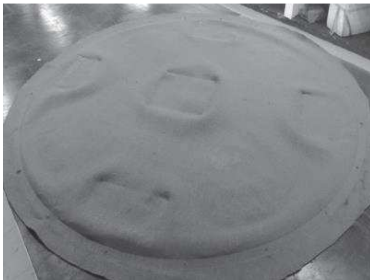
Figura 2 - Geotêxtil retirado de modelo físico reduzido após ensaio.
