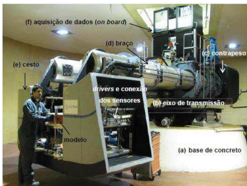
Figura 3 - Centrífuga localizada no IFFSTAR ( Institut Français des Sciences et Technologies de Transports ), na França.
