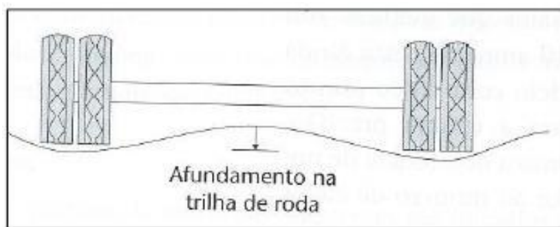
Figura 22- Exemplo de afundamento de trilha de roda (ATR).
