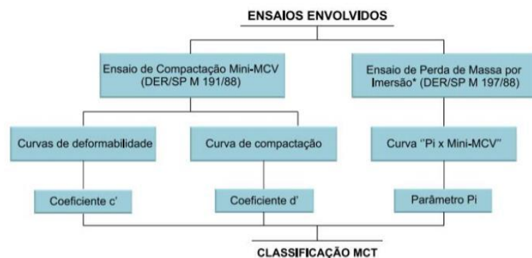
Figura 12- Ensaios, coeficientes e parâmetro necessários para a classificação MCT.
