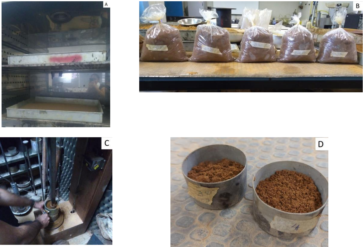
Figura 29- Procedimentos ensaio de compactação: (A) Solo destorroado (B) Amostra homogeneizadas com os cinco pontos de umidade (C) Compactação de um corpo de prova (D) Amostra do corpo de prova a ser levado para a estufa.
