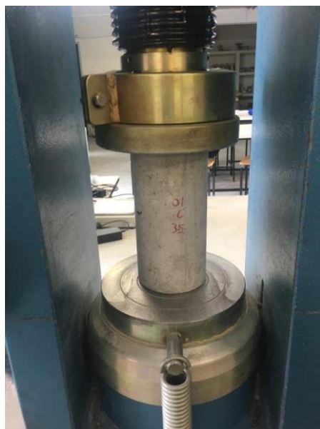
Figura 19 - Ensaio de resistência à compressão axial.
