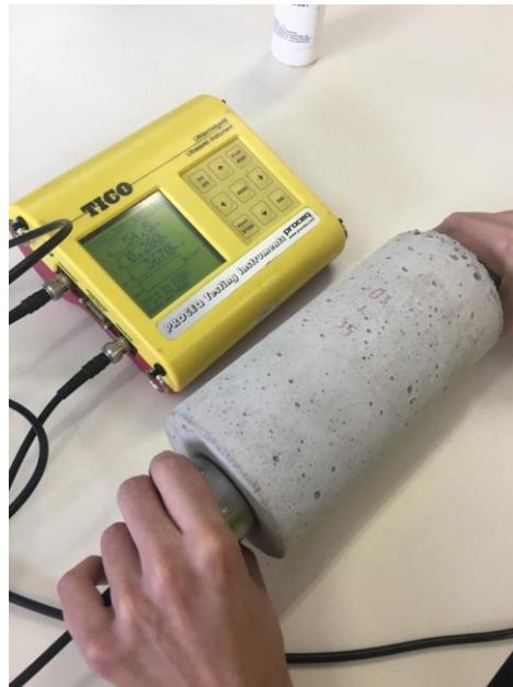
Figura 17 - Ensaio de velocidade do pulso ultrassônico.
