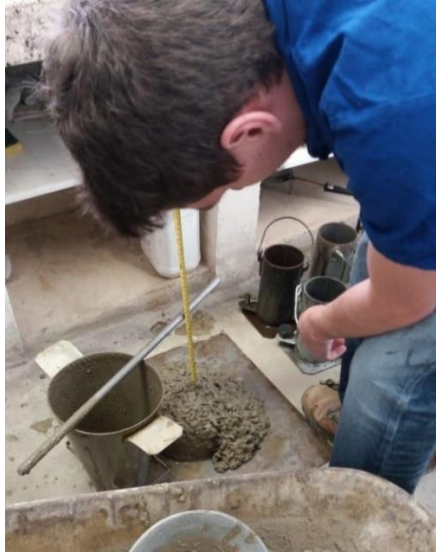
Figura 14 - Medição do abatimento.
