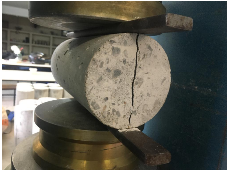
Figura 20 - Ensaio de tração por compressão diametral.
