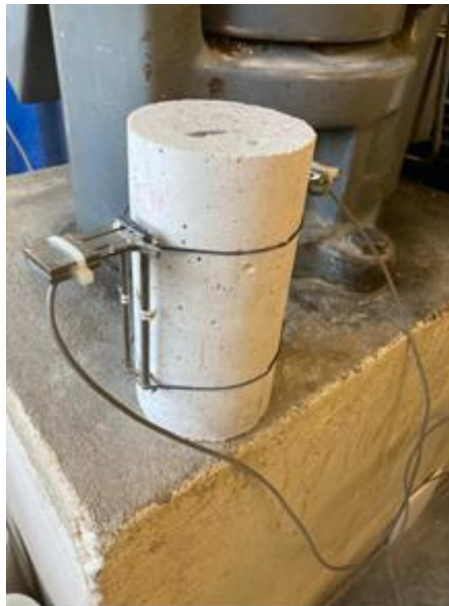
Figura 21 - Strain Gauge colocado no corpo de prova.
