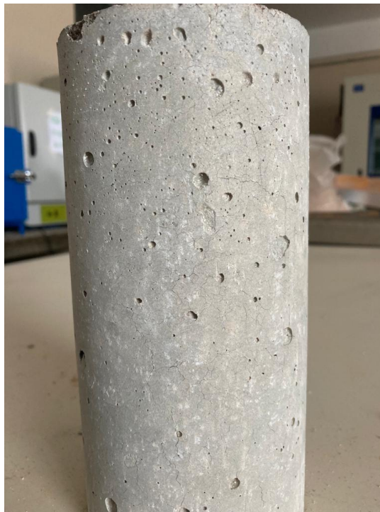
Figura 25 - Corpo de prova CR50 após aquecimento até 400^{\circ}\text{C} .
