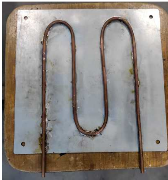
Figura 3.25: Placa galvanizada de zinco com o tubo de cobre soldado em sua superfície. A solda foi necessária para aumentar a superfície de contato entre a placa e o tubo, melhorando a transferência de calor por condução.
