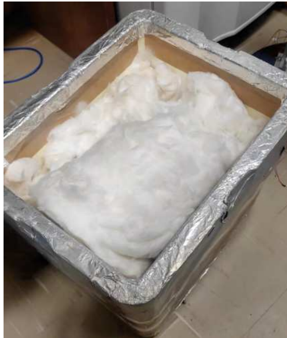
Figura A.5: Foto da caixa de isopor preenchida com lã de vidro utilizada no experimento. O aparato foi posicionado próximo à altura média da caixa.
