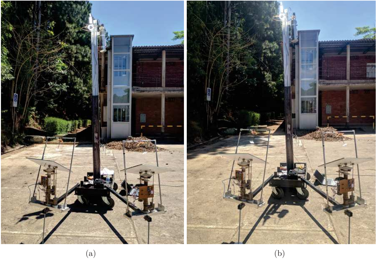
Figura 4.1: Fotos da PCH em teste. Em (a) temos o início do experimento e em (b) o final. Observe que as inclinações dos refletores em (a) são diferentes das de (b), durante todo o experimento a radiação foi mantida no receiver .
