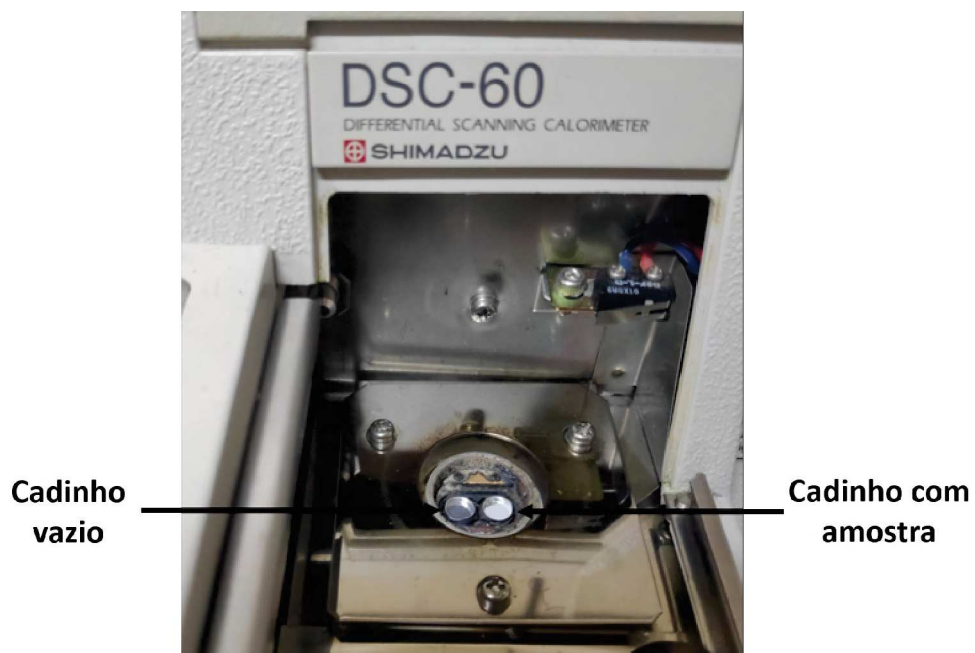
Figura 3.33: Posicionamento dos cadinhos no forno. A esquerda deve ser posicionado o cadinho vazio e a direita o cadinho com a amostra.
