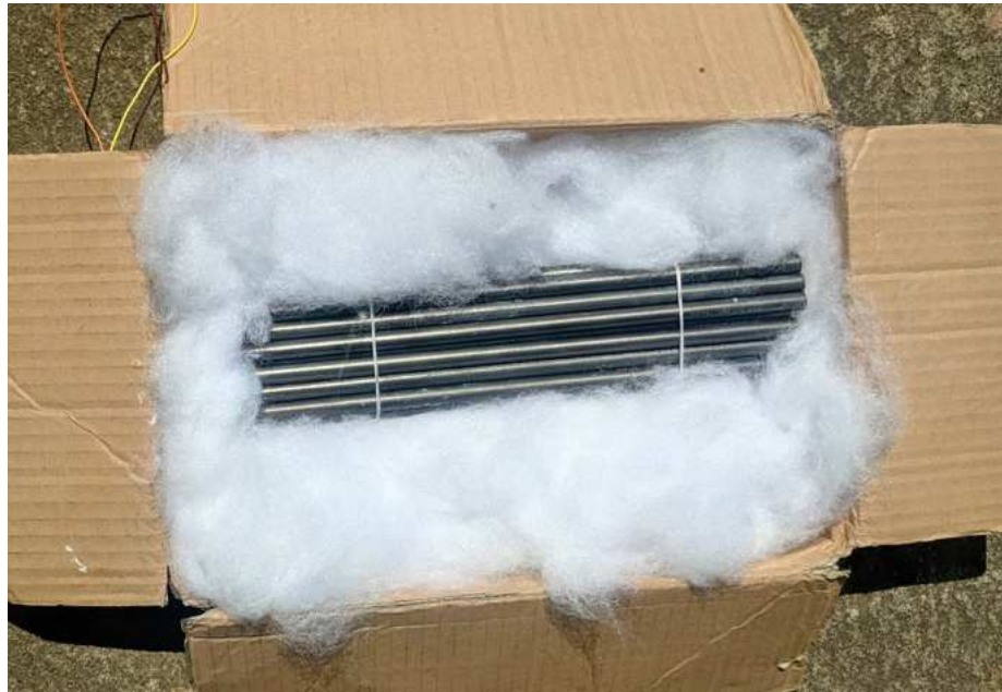
Figura A.1: Foto da caixa de papelão contendo os grafites e a lã de vidro.
