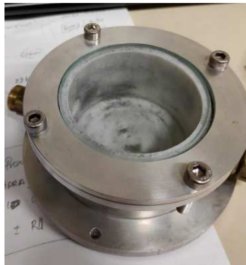
Figura 3.22: Receiver A sem as barras de grafite. A placa de vidro é presa por um anel de vedação. O ajuste da pressão é feito por quatro parafusos Allen .
