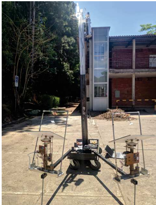
Figura 3.40: Foto da PCH desenvolvida, com o receiver A. O aparato possui dois helióstatos, um receiver , um reservatório e um sistema de bombeio.
