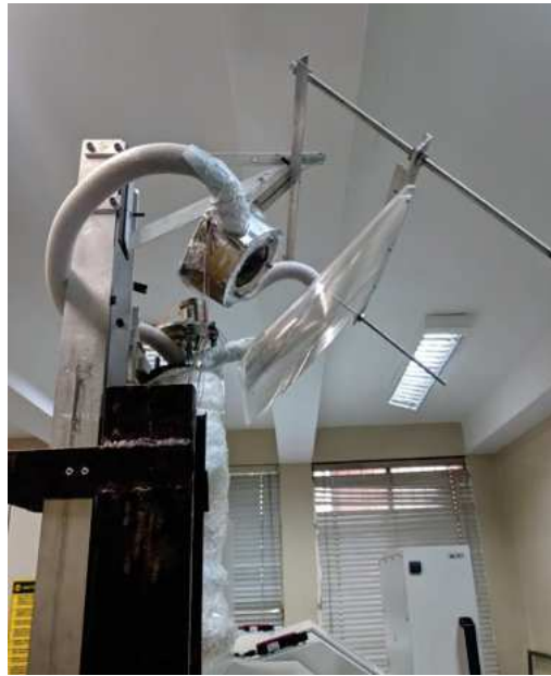
Figura 3.41: Foto da PCH com o isolamento térmico e uma lente de fresnel paralela ao receiver A .
