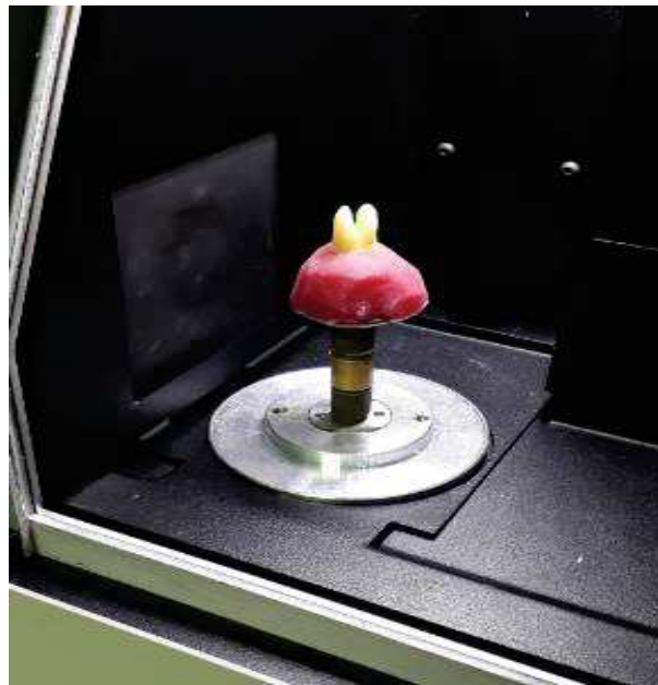
Figura 1- Dente posicionado no microtomógrafo antes do início do escaneamento
