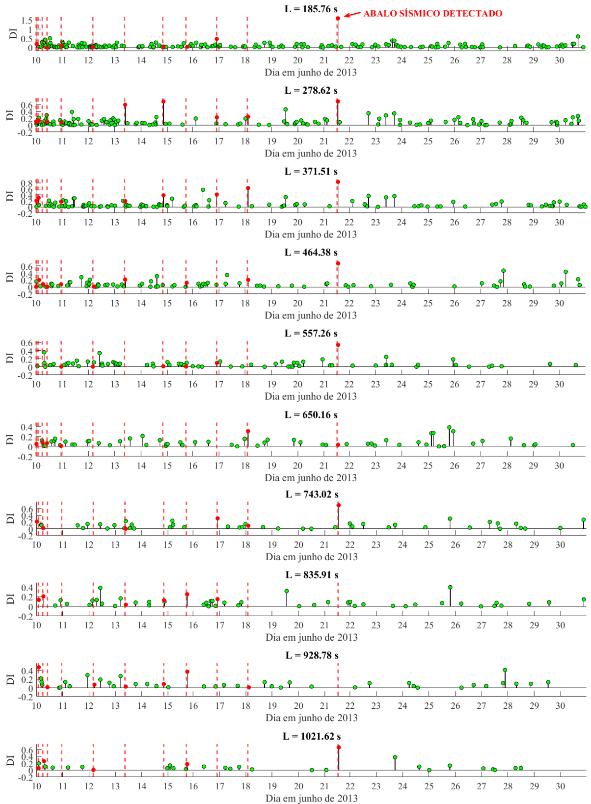
Figura 12 – Monitoramento da torre Gabbia realizado com o software ReTiA-SHM
