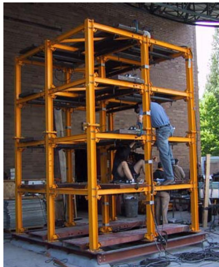
Figura 36 – Pórtico sem contraventamento
