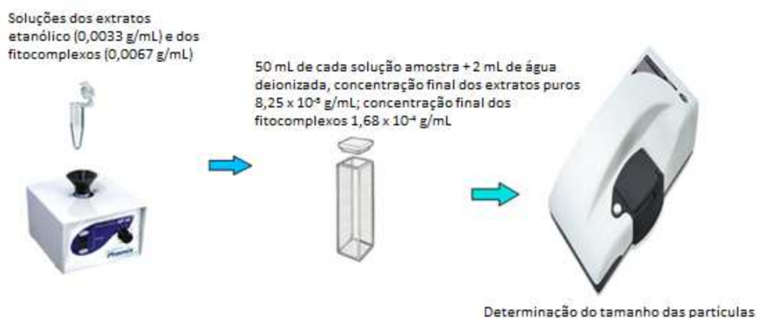
Figura 17 - Leitura das amostras por fotometria de espalhamento de luz dinâmico (DLS)
