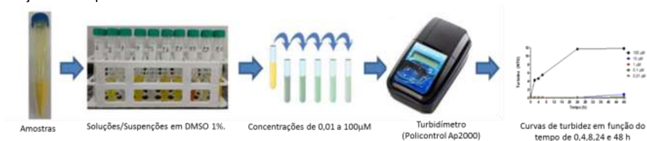
Figura 9. Esquema do experimento para determinação da turbidez da solução/suspensão em função do tempo.
