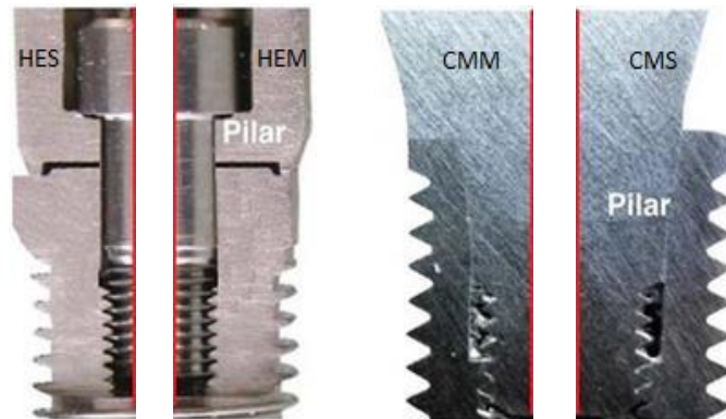
Figura 1: Implante hexágono externo e cone Morse e as variações de perfis de componentes protéticos estudados na pesquisa (Grupos HES; HEM; CMM; CMS).
