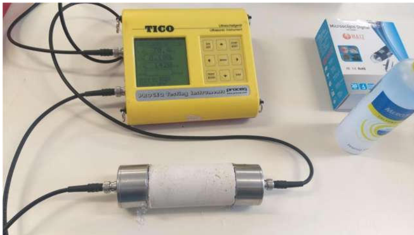
Figura 61: Determinação de módulo de elasticidade estimado por ultrassom.
