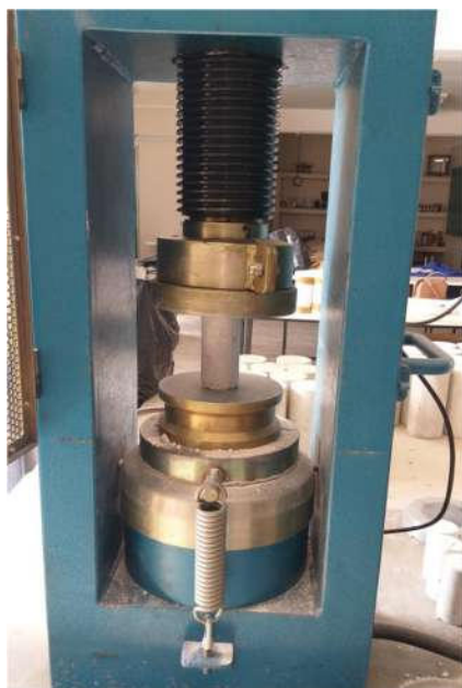
Figura 54: Ensaio de resistência à compressão
