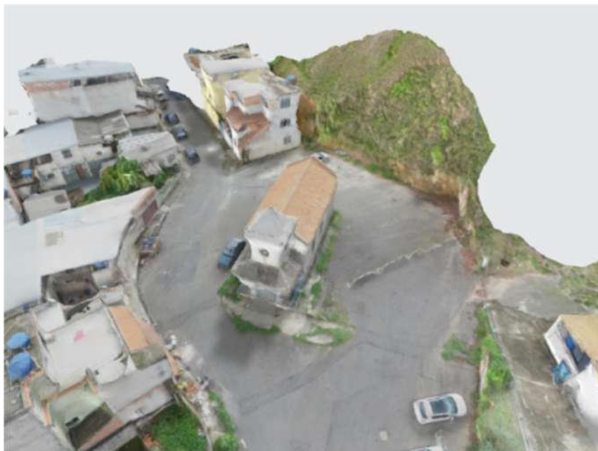
Figura 49: Modelo geométrico tridimensional obtido por escaneamento a laser 3D.
