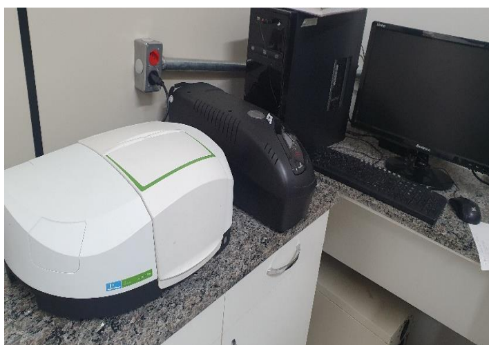
Figura 21 - Espectrofotômetro de infravermelho utilizado na caracterização das gomas
