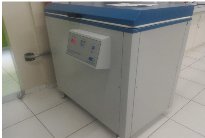
Figura 19 - Incubadora refrigerada Shaker utilizada na fermentação das gomas
