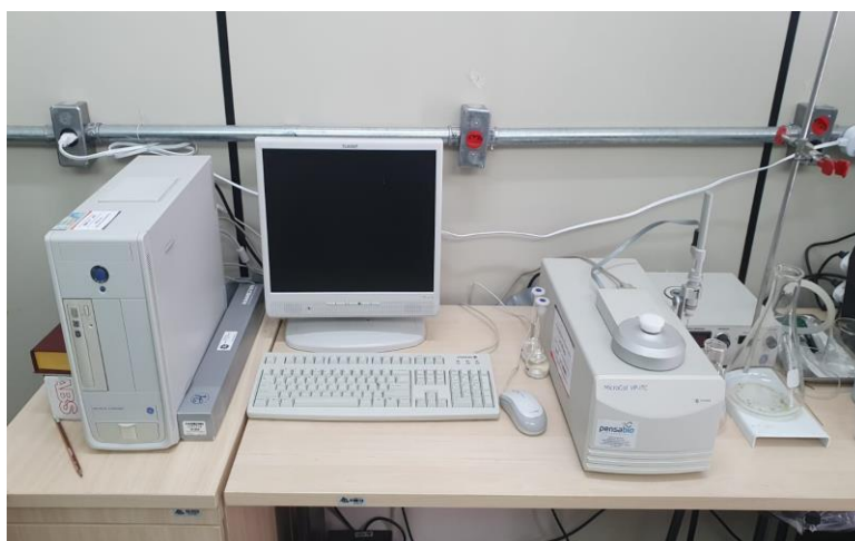
Figura 28 - Microcalorímetro VP-ITC utilizado na determinação de propriedades termodinâmicas
