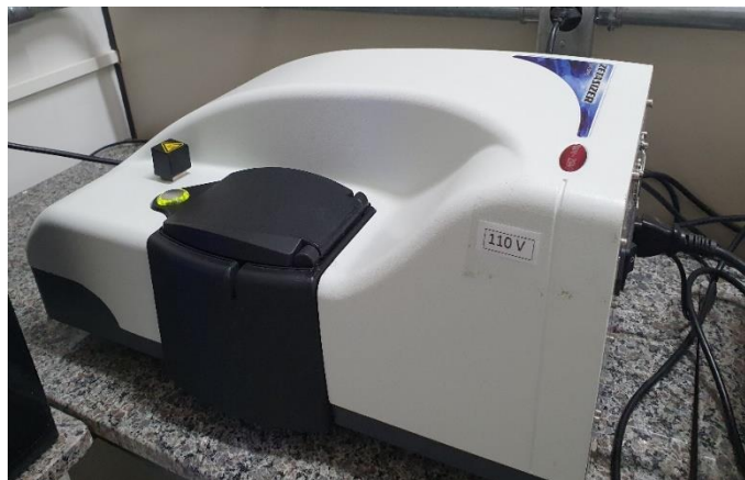
Figura 23 - Medidor de potencial zeta (ZP) e diâmetro hidrodinâmico (Dh)
