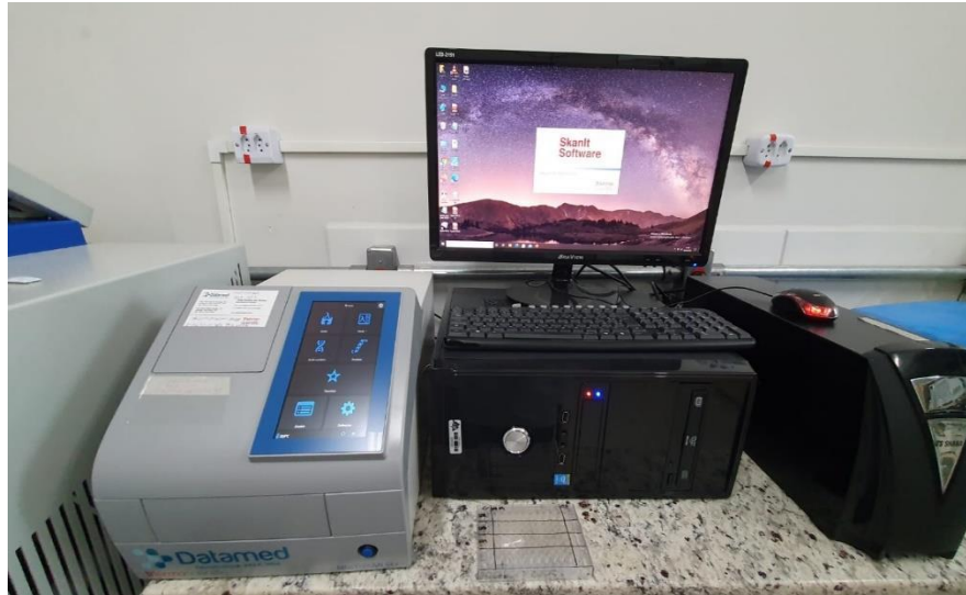
Figura 30 - Espectrofotômetro de placas Multiskan utilizado na leitura de placas
