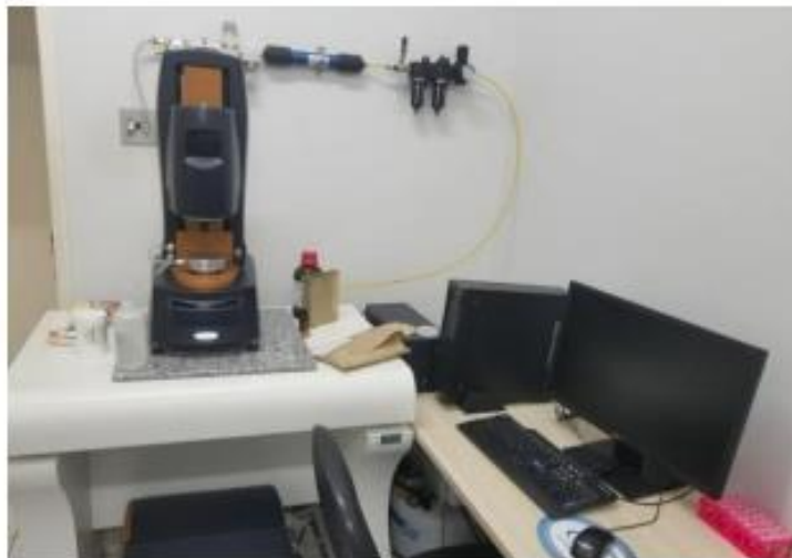
Figura 24 - Rêmetro DHR1 utilizado para caracterização das gomas
