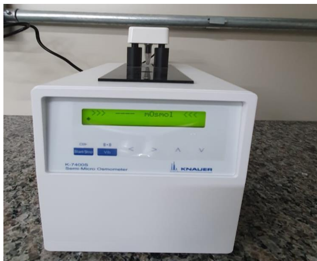
Figura 25 - Osmômetro de ponto de congelamento utilizando para caracterização das gomas
