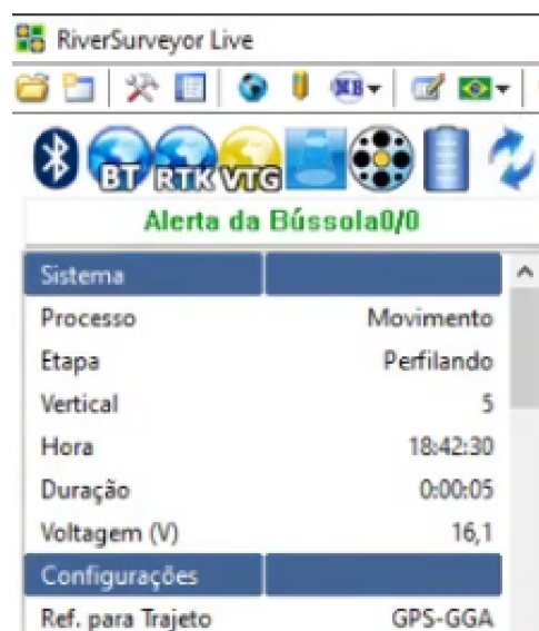
Figura 64 – RiverSurveyor exibindo status de conexão correta com receptor GNSS RTK
