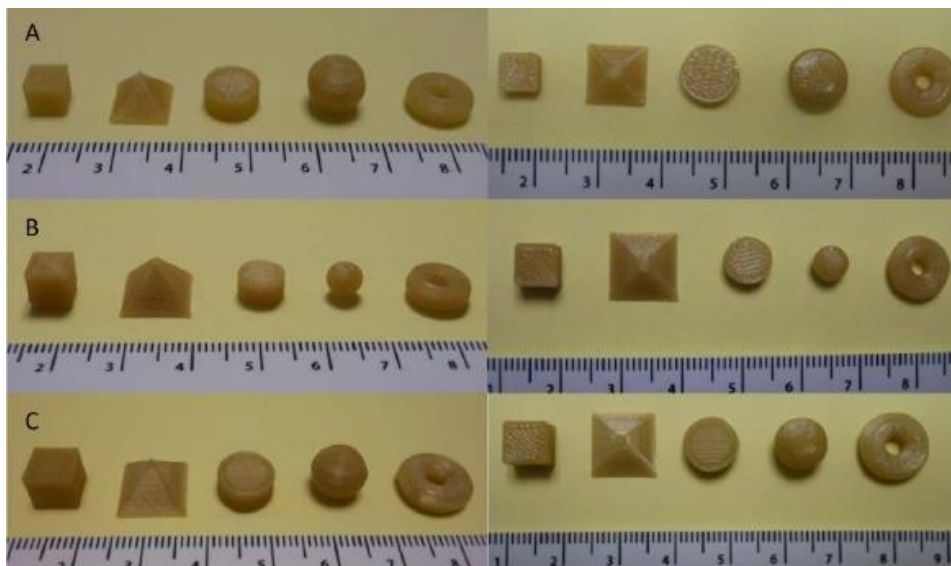
Figura 12 – Comprimidos com diferentes geometrias produzidos por FDM.
