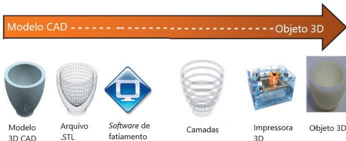
Figura 1 – Esquema ilustrando as etapas básicas da impressão 3D.
