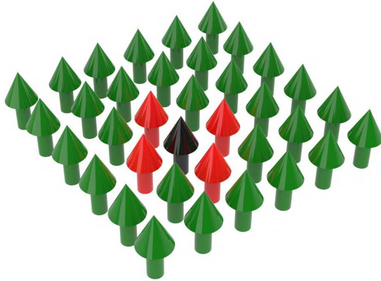
Figura 5 – Representação dos pares de momentos magnéticos que interagem no processo de troca em uma rede ferromagnética. Em preto representa um spin aleatório na rede e em vermelho seus primeiros vizinhos no qual ocorre a interação.
