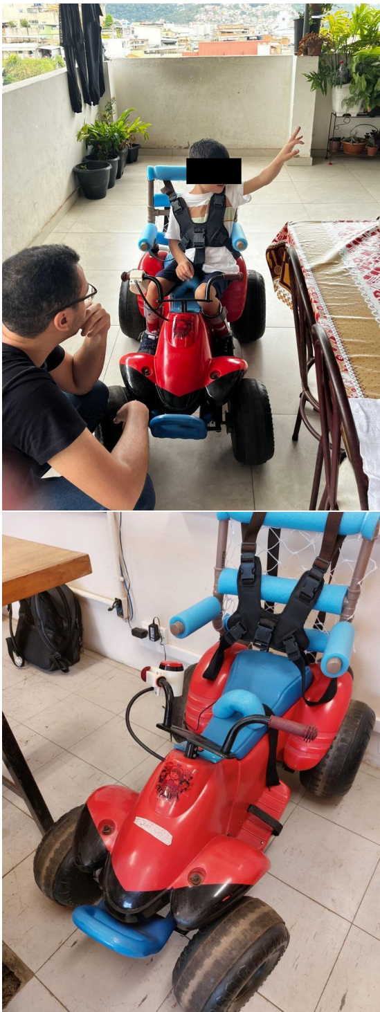
Figura 3: Adaptações realizadas no carro motorizado da Criança 2 (fotos Arquivo pessoal do Projeto Adapt - UFJF)
