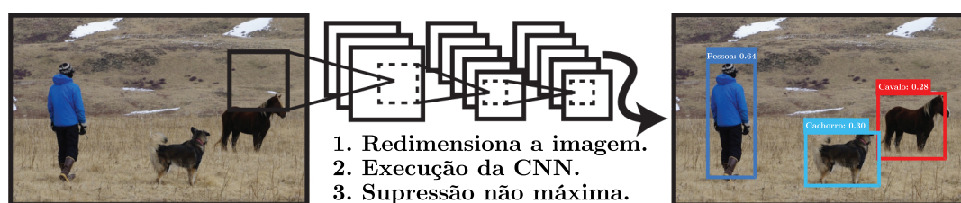
Figura 4 – O sistema de detecção YOLO .
