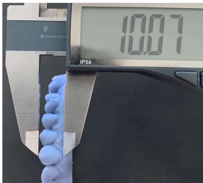
Figura 3: Imagem da medição de altura do longo eixo do dente com paquímetro digital no modelo impresso para obtenção da medida vertical
