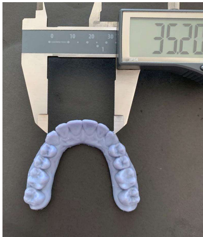
Figura 2: Imagem da medição de distância intercuspídea com paquímetro digital no modelo impresso para obtenção das medidas horizontais.
