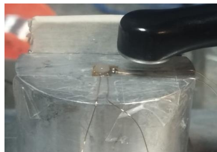
Figura 13: Cimento posicionado sobre o extensômetro e fotopolimerizador posicionado a 1mm.
