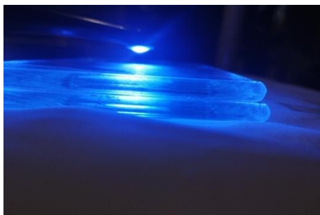
Figuras 8: Fotopolimerização do conjunto placa-cimento-placa.
