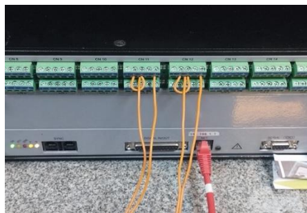
Figura 11: Ligação ¼ de ponte para obtenção dos dados de contração.
