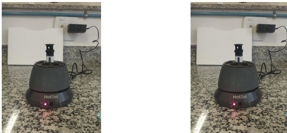
Figura 2: Cimentos inseridos no dispositivo de pré-aquecimento Hotset®.
