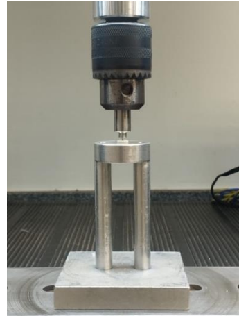
Figura 23: Conjunto montado com ponteiras e base para o ensaio de push-out .
