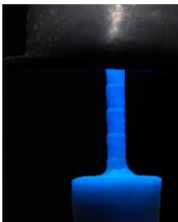
Figura 19: Fotopolimerização do pino de fibra de vidro após 5 minutos
