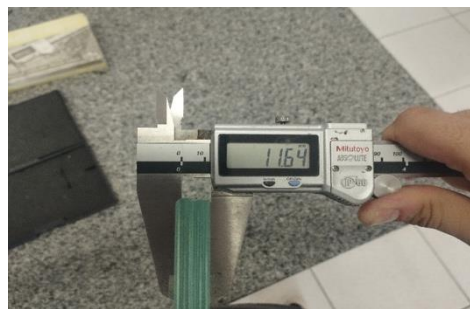
Figura 9: Medição da espessura do conjunto após a fotopolimerização.
