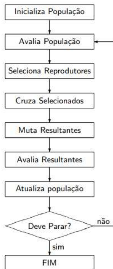
Figura 16 – Fluxograma mostrando as principais etapas de um algoritmo genético básico [11].
