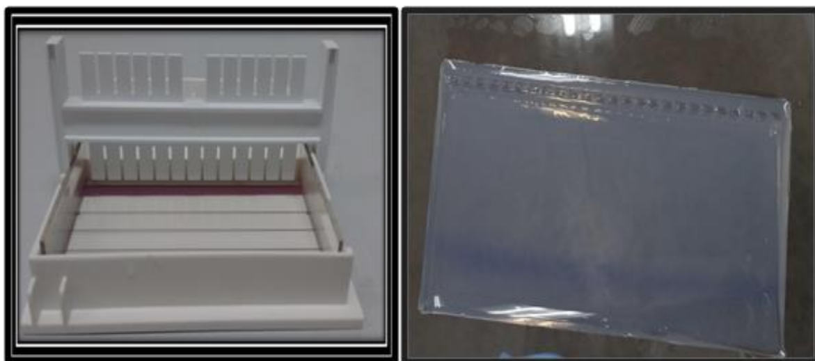
Figura 16 —Montagem do recipiente utilizado para formação do gel e poços de deposição. Gel de agarose. Imagem realizada pela autora da tese.
