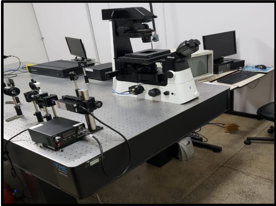
Figura 6 – Aparato gerador da Pinça Óptica. Imagem realizada pela autora da tese.
