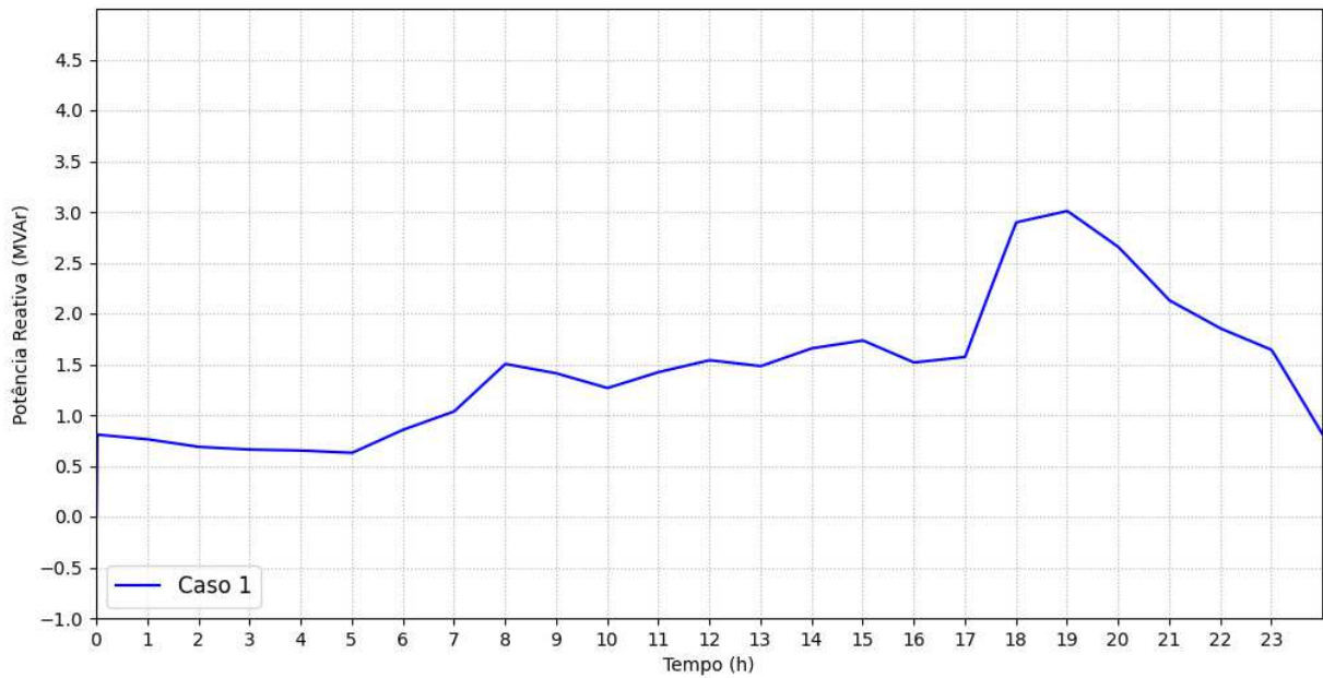
Figura 25 – Curva de potência reativa da subestação referente ao caso base.
