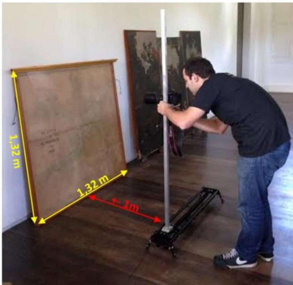
Figura 11 – Sistema utilizando trilho, baliza e câmera digital de alta resolução para levantamento fotográfico da planta de Petrópolis de 1846
