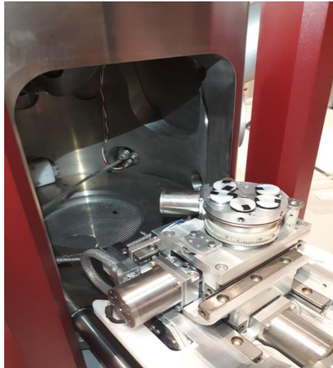
Figura 8 - Plataforma de alumínio (stub) do MEV com amostras posicionadas
