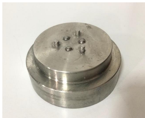
Figura 6 – Dispositivo metálico para fixação das amostras no equipamento
