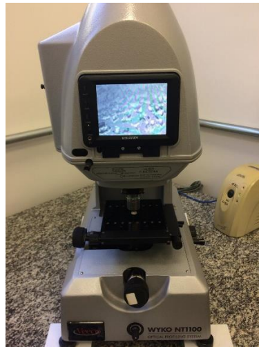
Figura 7 – Perfilômetro óptico digital com amostra posicionada (LAS-NPE)
