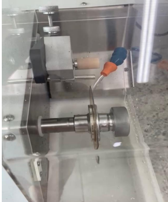
Figura 2 – Máquina de corte e disco de corte diamantado montados para fatiar o cilindro de cerâmica em discos.
