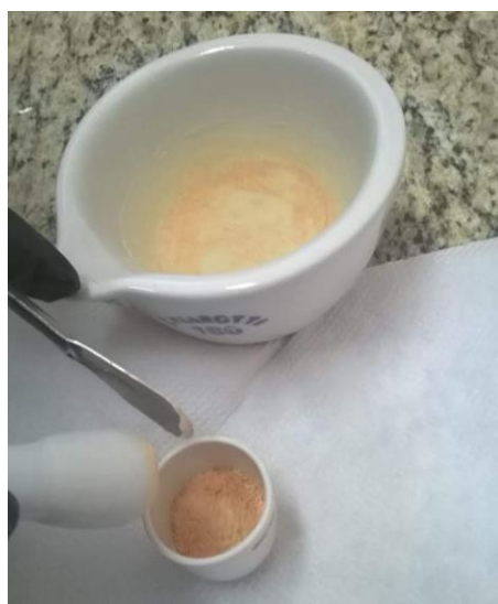
Figura 17: Síntese dos materiais com almofariz, pistilo e cadinho descartável de porcelana.
