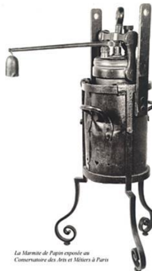
Figura 11- Representação do dispositivo proposto por Papin.
