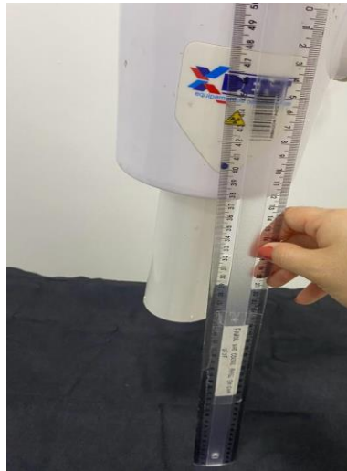
Figura 2 – Distância foco-PSP de 40 cm.
