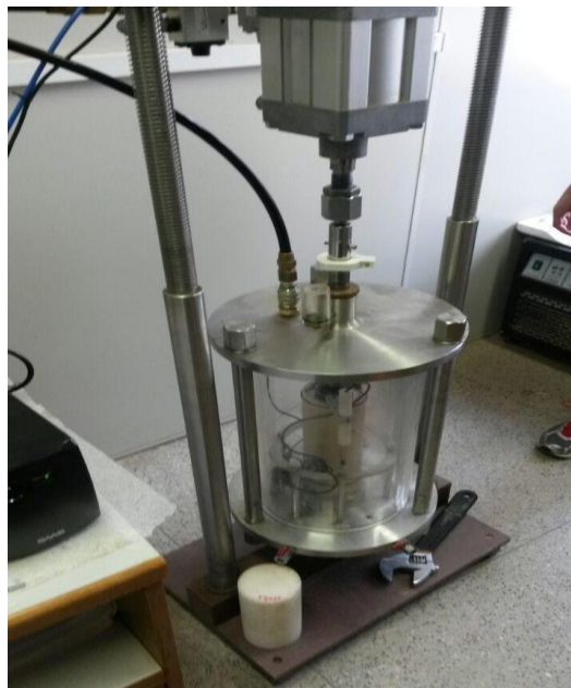
Figura 7 – Célula triaxial pronta para início do ensaio
