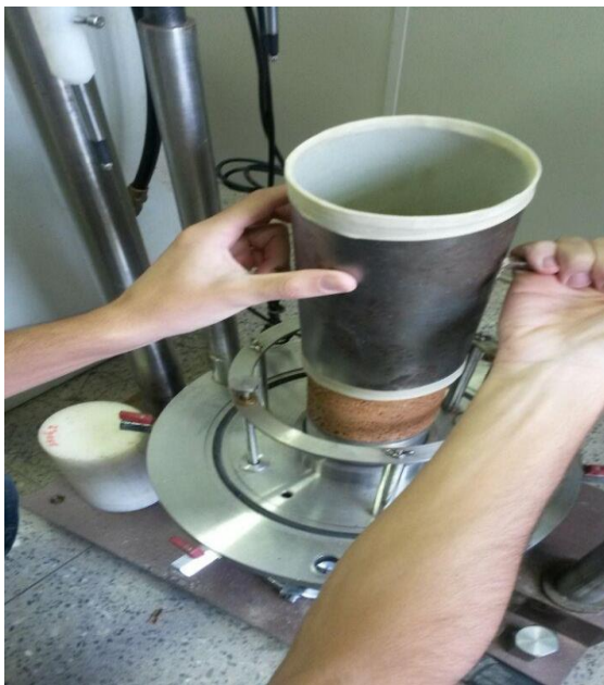
Figura 5 – Colocação da membrana de borracha no corpo de prova
