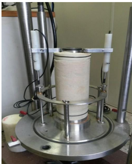
Figura 6 – Detalhe da montagem do ensaio triaxial dinâmico
