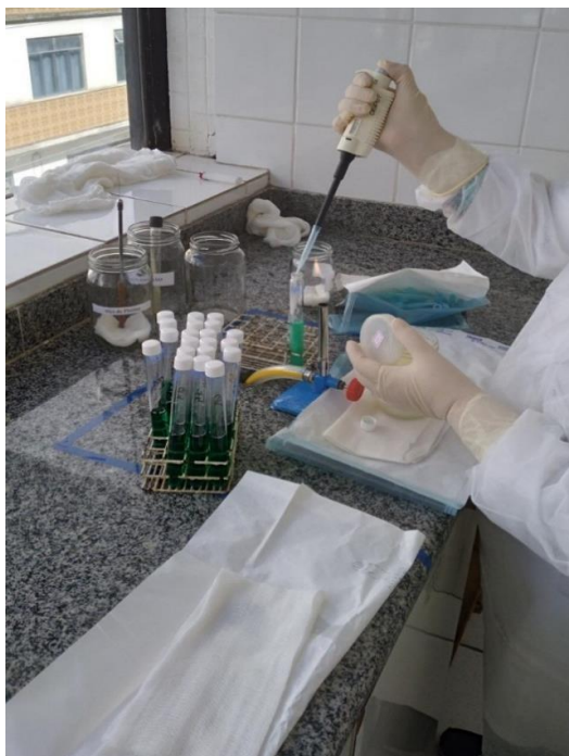
Figura 13: Teste simplificado para detecção de Coliformes Totais no banco de leite de Juiz de Fora.
