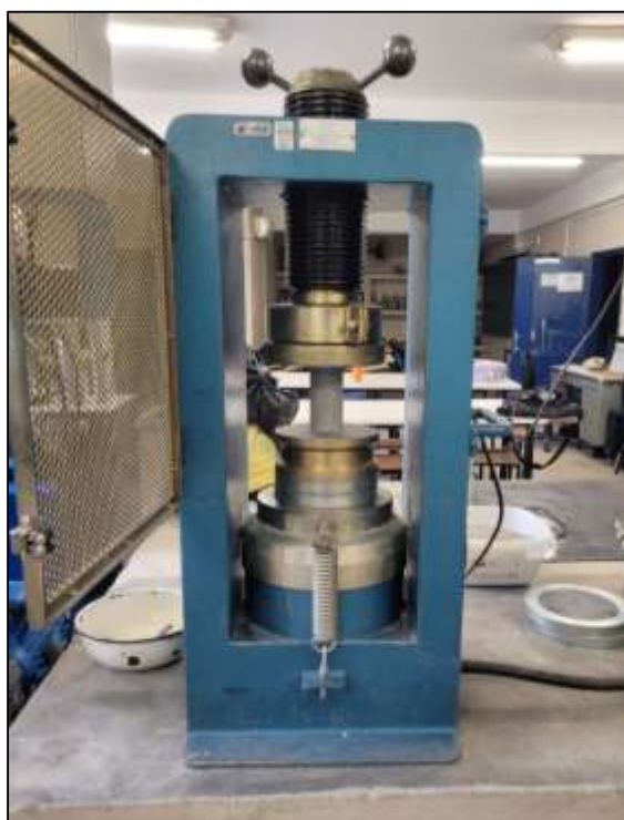
Figura 22 - Ensaio de resistência à compressão
