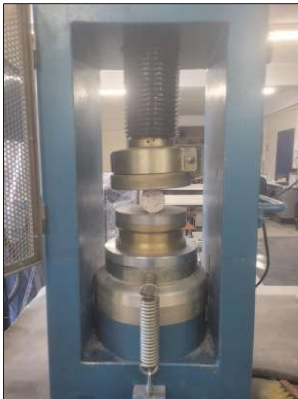
Figura 23 – Ensaio de resistência à tração por compressão diametral
