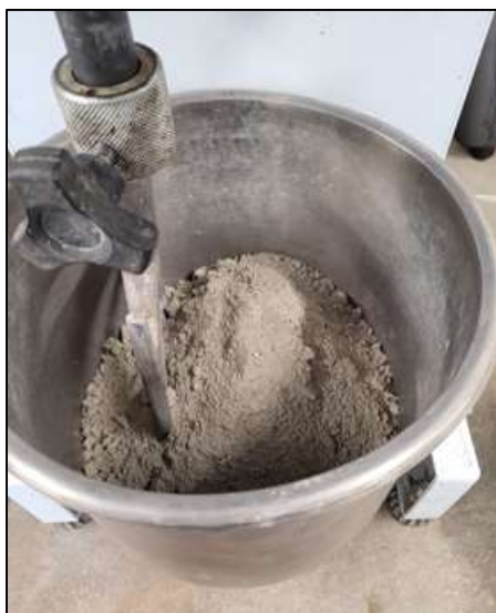
Figura 16 - Materiais da mistura do concreto na argamassadeira.
