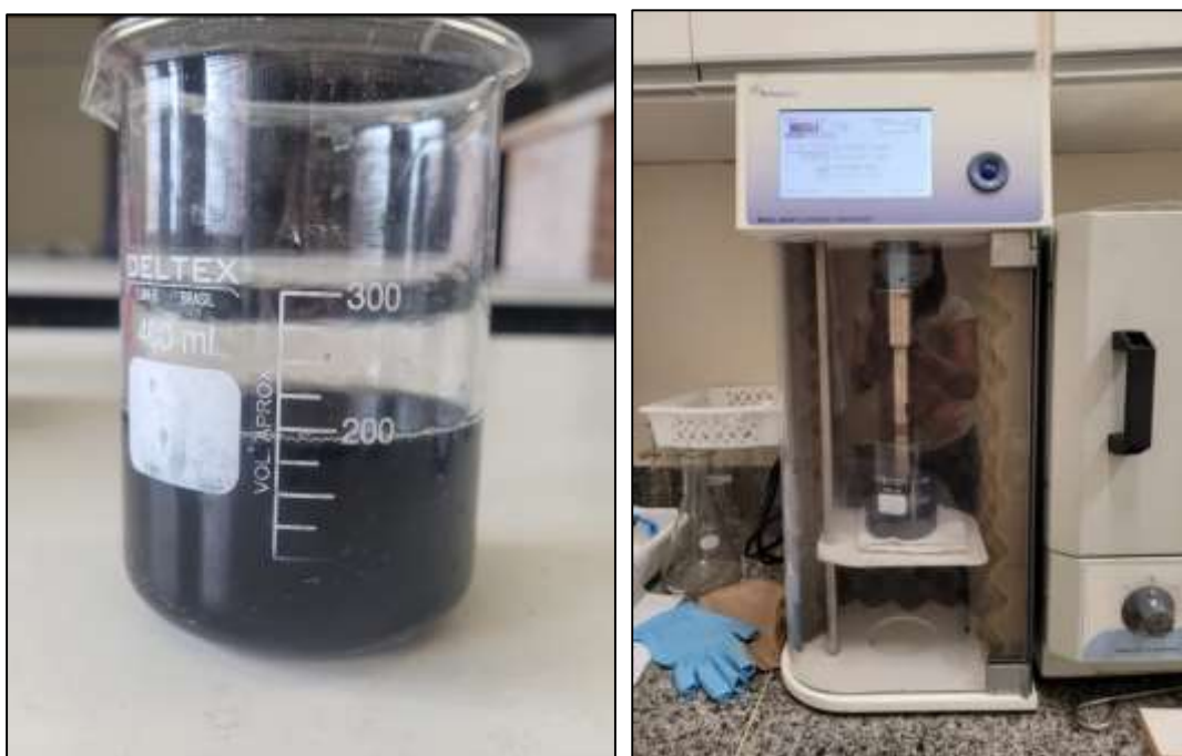
Figura 17 – a) Solução com água, aditivo policarboxilato e NTCs b) Solução aquosa com NTCs no homogeneizador ultrassônico
