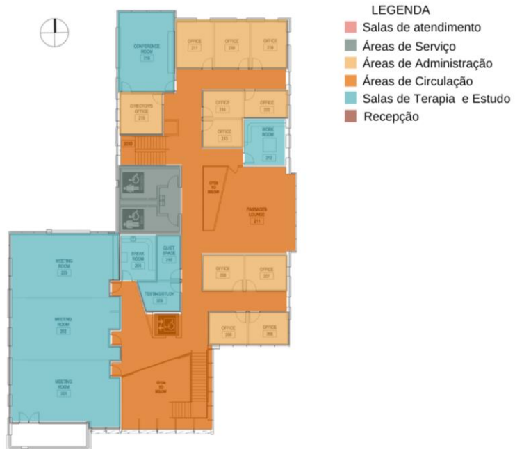
Fig.15 - Planta de Setorização 2º Pavimento.
