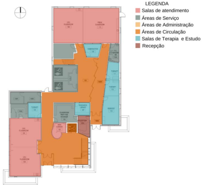
Fig.14 - Planta de Setorização 1º Pavimento.
