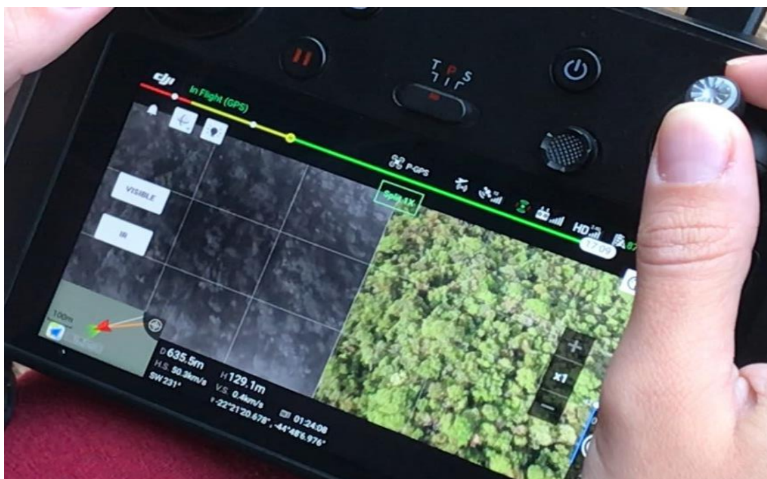
Figura 4. Detalhes do controle remoto do drone (M2EA), demonstrando como visualizamos a tela no momento do voo, com os dois tipos de imagens (térmica e colorida), que são transmitidas e capturadas através da câmera termal e da câmera visual.
